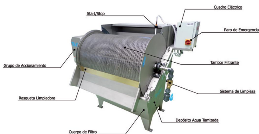
Figura 19: Elementos de un Tamiz Rotatorio
