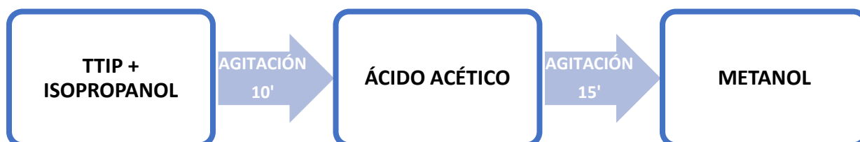
Figura 7. Esquema de síntesis de sol-gel de TiO 2
