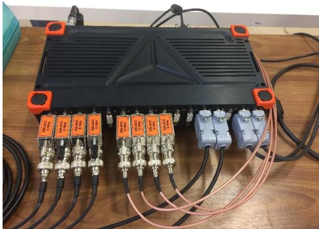
Ilustración 6. Tarjeta de adquisición de datos
