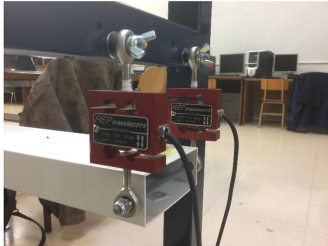
*Ilustración 4. Células de carga*
