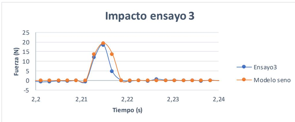
Ilustración 17. Comparación de la función impacto seno, con los datos prácticos.
