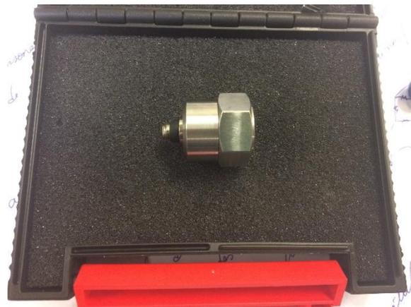
*Ilustración 5. Acelerómetro*
