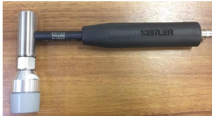
Ilustración 14. Roving hammer
