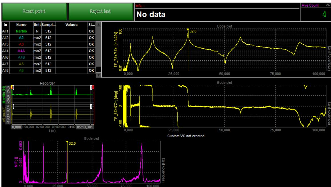
Ilustración 7. Apariencia del software "Dewesoft" tras un ensayo
