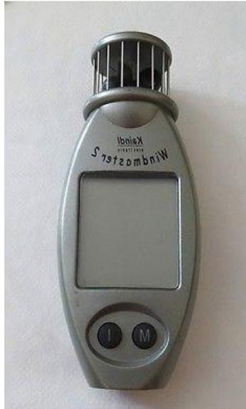
**Figura 55.** Anemómetro de cucharas Windmaster 2.
