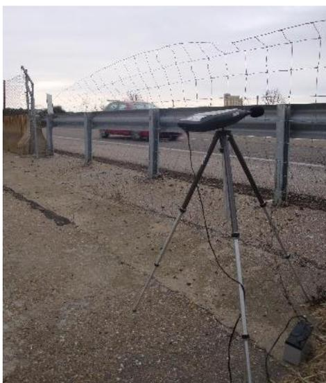
**Figura 90.** Posición del sonómetro durante las mediciones en la autopista A-6.
