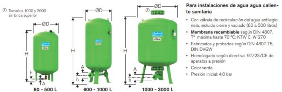
Imagen 72. Características geométricas de los vasos de expansión DT
