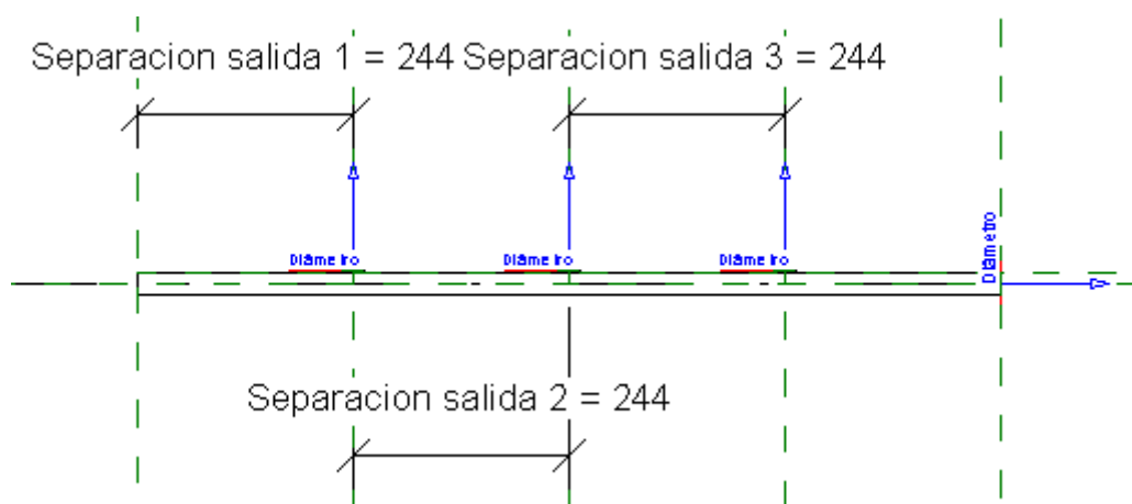
Imagen 83. Alzado colector 3 salidas (1")
