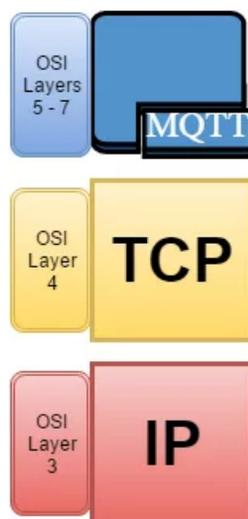
Figura 4.2: MQTT sobre capas OSI
