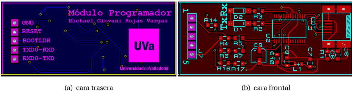
Figura 3.15: Layout del módulo programador
