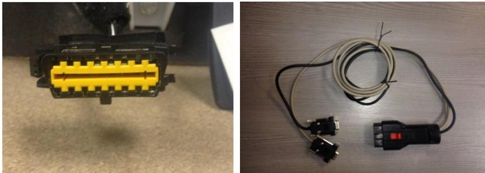
Figura 3.5. OBD-II y Conector particular para Renault Captur
