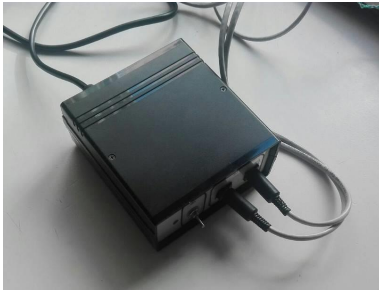
Figura 2.52. Vista general de la caja de circuitos, ya conectados los cables de las zapatillas y la alimentación
