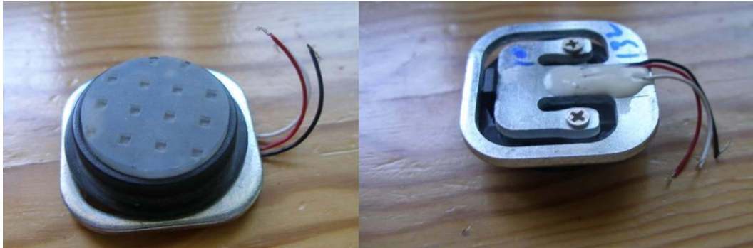
Figura 2.14. Fotografías de la galga extensiométrica, sin la protección de plástico
