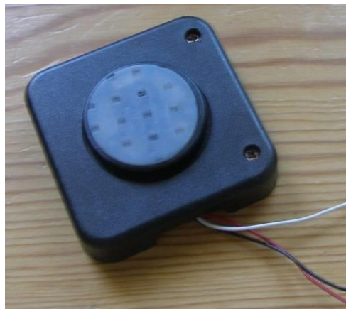
Figura 2.13. Fotografía de la galga extensiométrica a utilizar, con la protección de plástico
