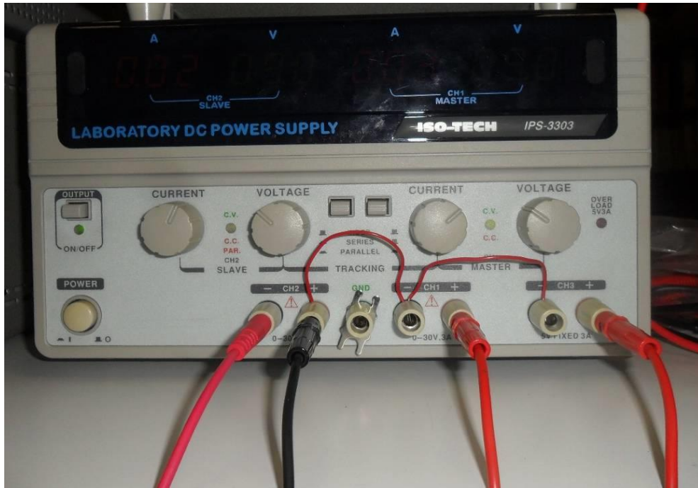
Figura 4.5. Fotografía de la distribución de cables en la fuente de alimentación (de izquierda a derecha: -9, 0, 9 y 5 V)
