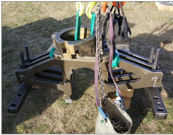
Imagen 13 y 14: “Fixture” Sistema de fijación del eje lento del rotor para su sujeción.
