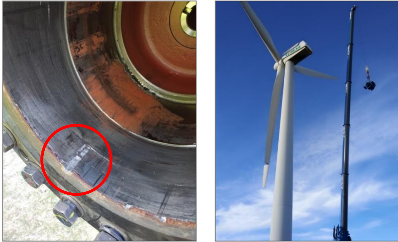
Imágenes 17 y 18: Anillo cónico de la multiplicadora con arrastre de viruta. Descenso de multiplicadora.
