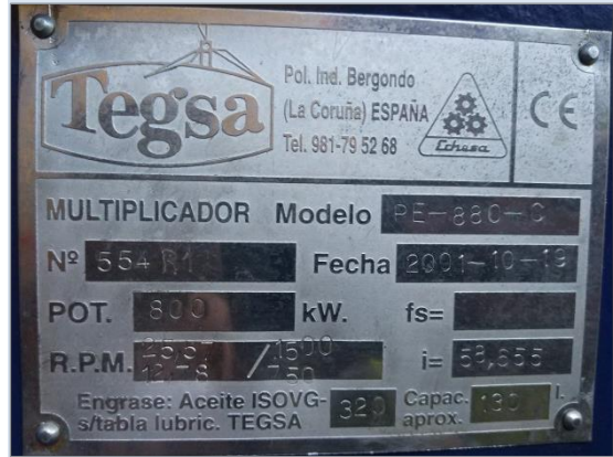
Figura 12: Multiplicadora de los parques de Castilfrío y El Cayo.
