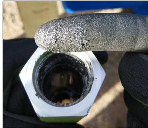
Imágenes 6 y 7: Prefiltro colmatado de viruta.
