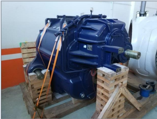
Figura 12: Multiplicadora de los parques de Castilfrío y El Cayo.
