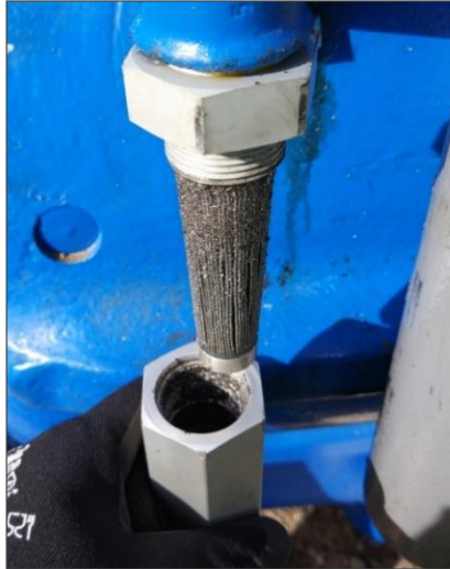
Imágenes 6 y 7: Prefiltro colmatado de viruta.
