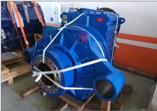
Figura 13: Multiplicadora del parque Oncala.
