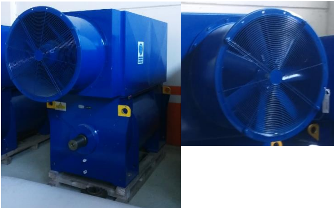
Figura 13: Foto generador Made y detalle sistema de refrigeración por electroventilador. Elaboración propia
