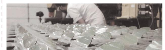
El concepto se basa en un sistema personalizado desarrollado por Zahner. Las pestañas de acero inoxidable cortadas con láser se plegan en persianas, controlando la entrada de luz el edificio. Cada una de las pestañas perforadas hacia afuera con la inclinación deseada de cada zona.
