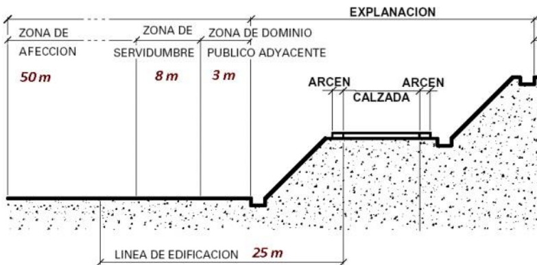
Sección afecciones Ley 37/2015 Carreteras.
