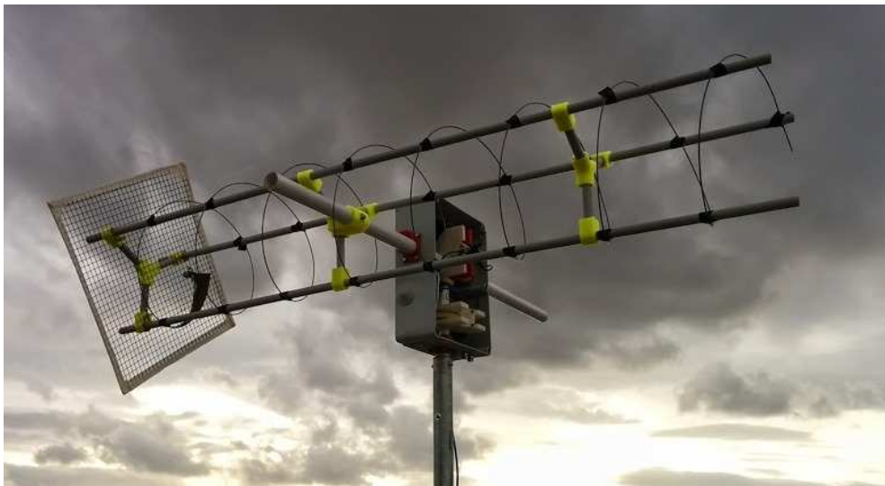
Figura 10. Antena autoconstruida del proyecto SatNOGS
