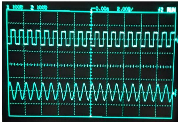
Figura 37: Canal 1: Señal de entrada: cuadrada,  $f_o = 1$  kHz y amplitud 100 mVp-p; Canal 2: Señal salida filtro paso banda  $f_o = 1$  kHz dominio del tiempo.
