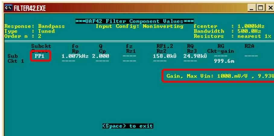
Figura 33: Implementación filtro paso banda  $f_0 = 1$  kHz.
