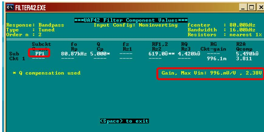
Figura 74: Implementación filtro paso banda  $f_o = 80$  kHz.
