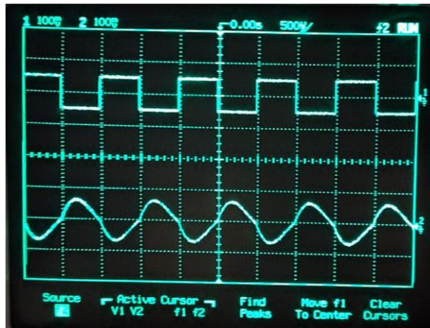
Figura 61: Canal 1: Señal de entrada: cuadrada,  $f_0 = 1$  kHz y amplitud 100 mVp-p. Canal 2: Señal salida filtro paso banda  $f_0 = 1$  kHz en el dominio del tiempo.
