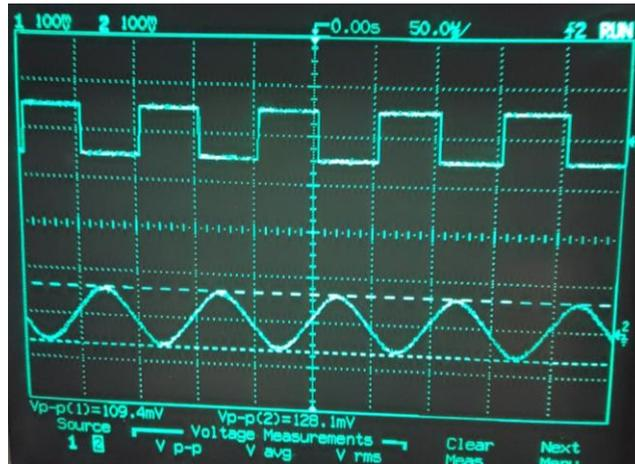
Figura 66: Canal 1: Señal de entrada: cuadrada,  $f_0 = 10$  kHz y amplitud 100 mVp-p. Canal 2: Señal de salida filtro paso banda  $f_0 = 10$  kHz en el dominio del tiempo.
