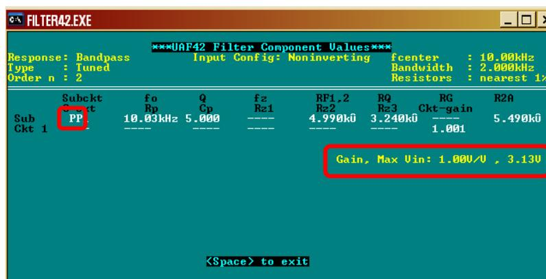
Figura 64: Implementación filtro paso banda  $f_0 = 10$  kHz.
