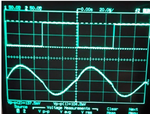
Figura 43: Canal 1: Señal de entrada: cuadrada,  $f_0 = 10$  kHz y amplitud 100 mVp-p. Canal 2: Señal salida filtro paso banda  $f_0 = 10$  kHz en el dominio del tiempo.
