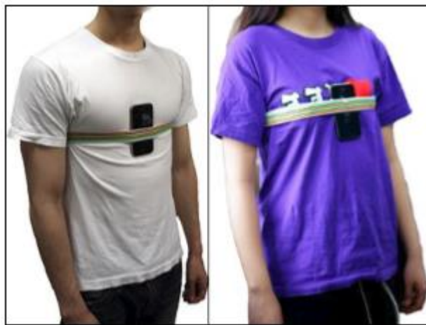
Figura 21: Medición del ritmo cardíaco mediante acelerómetro. [22]
