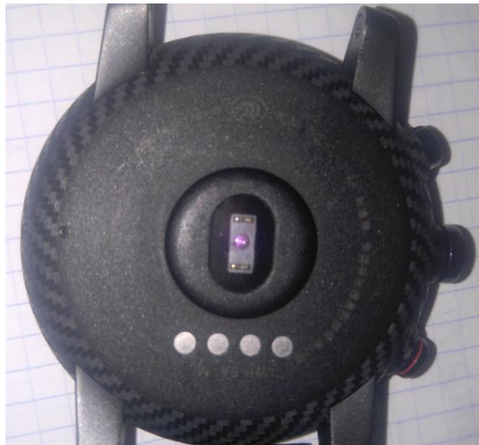
Figura 27: Sensor de pulso en la parte trasera de un smartwatch. Fuente: elaboración propia.
