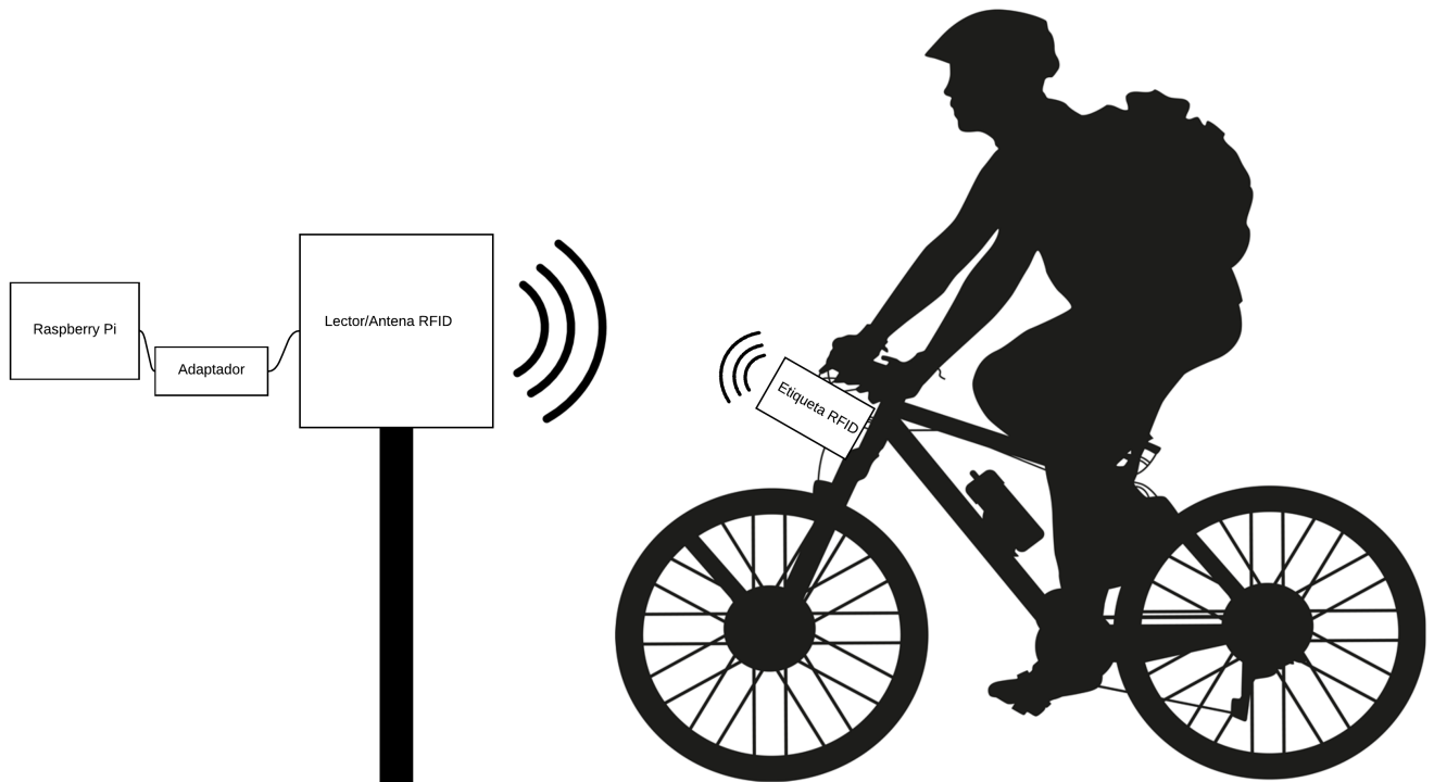
Figura 4.1: Esquema de funcionamiento y componentes de un equipo de cronometraje
