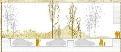
ACCESO NOROCCIDENTAL El acceso rodado al centro se realiza mediante una calle situada en paralelo a la línea ferroviaria de mercancías existente. Los coches se encuentran delimitados por el desnivel aterrazado y por el acceso desde el aparcamiento al edificio y se puede acceder a este tanto desde norte como desde sur.
