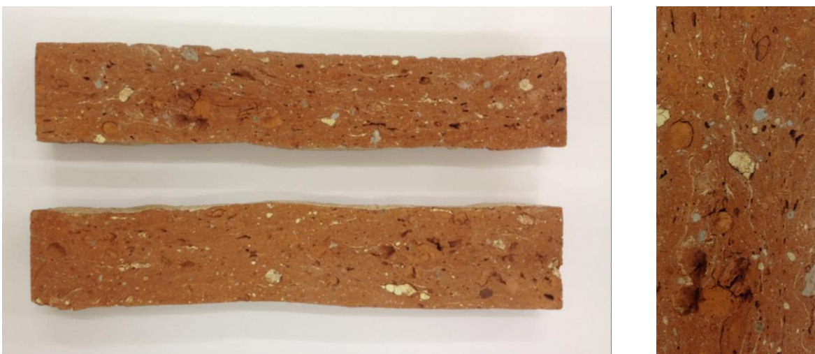
Imágenes 41 y 42. Ladrillos de tejar de "La Operaria" una vez cortados con la sierra de disco y detalle
