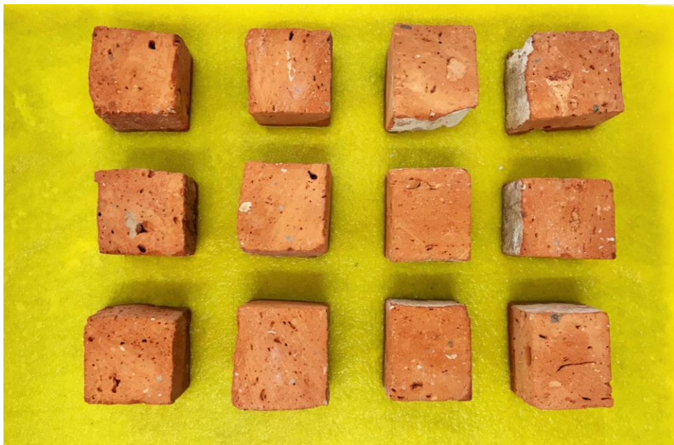
Imagen 124. Probetas cúbicas de ladrillos tipo "La Operaria" mientras se ejecuta el ensayo
