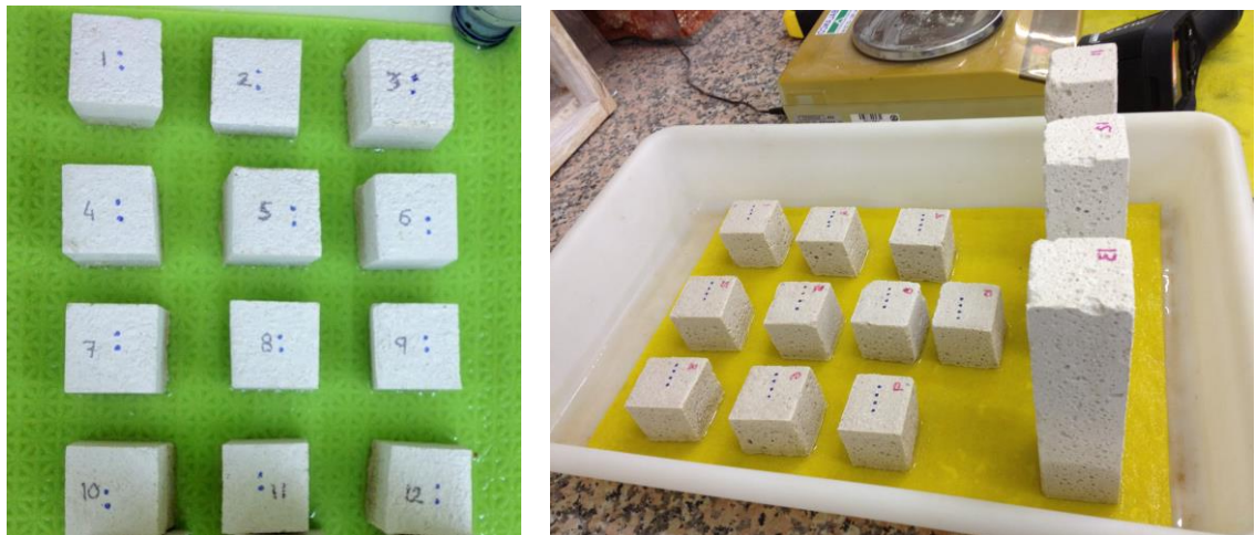
Imágenes 79 y 80. Probetas normalizadas de argamasa de 40 x 40 x 40 mm durante un ensayo junto a probetas de mayor dimensión
