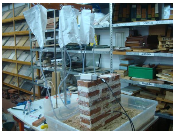
Imágenes 175 y 176. Izquierda, preparando la hidrofugación. Derecha, sondas tomado datos
