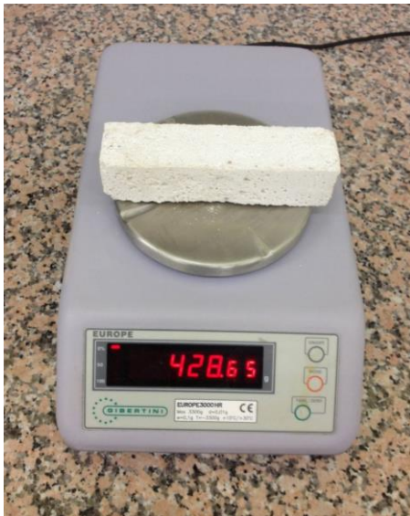
Imágenes 227 y 228. Pesado de probetas y una vez introducidas en la cámara climática
