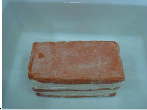
Imágenes 162 y 163. Probeta sumergida en agua fría
