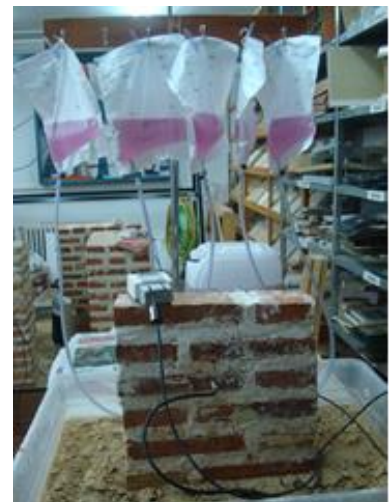
Imágenes 16 y 17. Ejemplo de introducción de producto hidrofugante por gravedad para generar una barrera de corte hídrico en dos de los ensayos realizados
