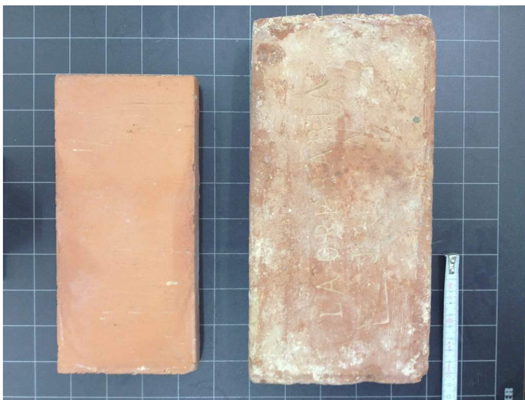
Imagen 29. Ladrillos seleccionados para ensayos. Izquierda, ladrillo moderno fabricado por extrusión tipo "Santoveña", a la derecha ladrillo antiguo de tejar elaborado manualmente tipo "La Operaria"
