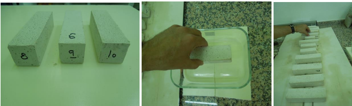
Imágenes 145, 146 y 147. Proceso de parafinado de las probetas.
