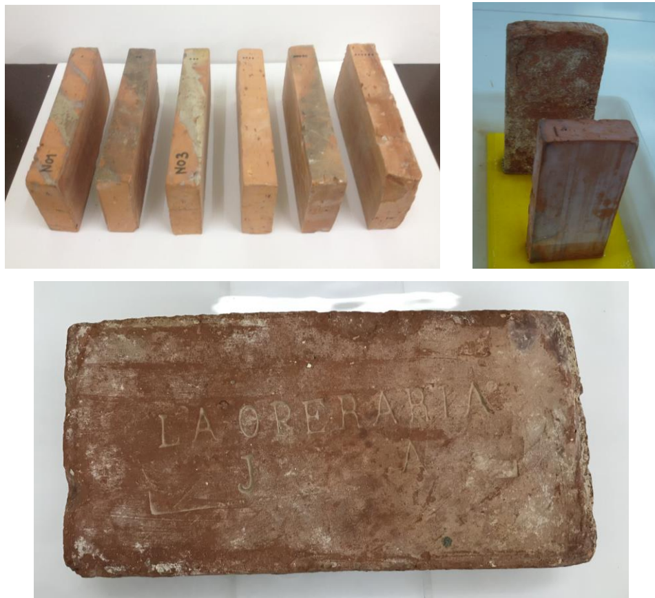
Imágenes 72, 73 y 74. Probetas de ladrillos enteros
