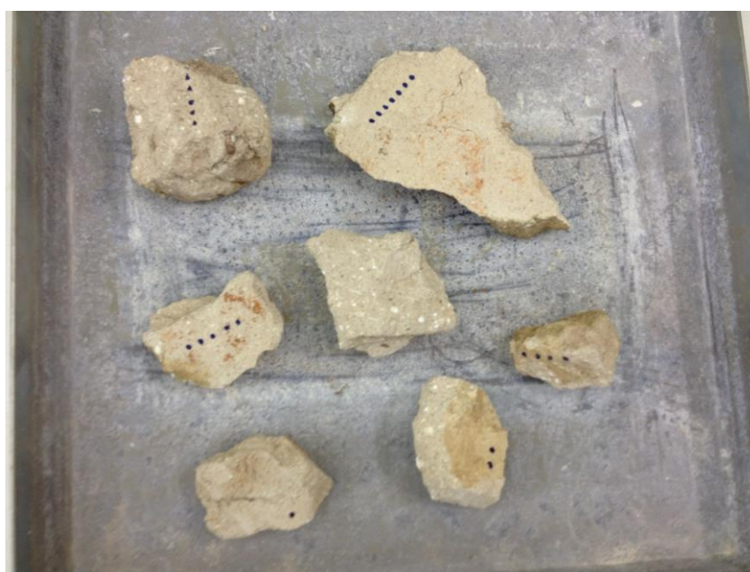
Imagen 82. Algunas de las probetas no normalizadas de trozos de argamasa de llagas y tendeles procedentes del derribo de edificios antiguos. Porciones de argamasas de cal antes de ser ensayadas
