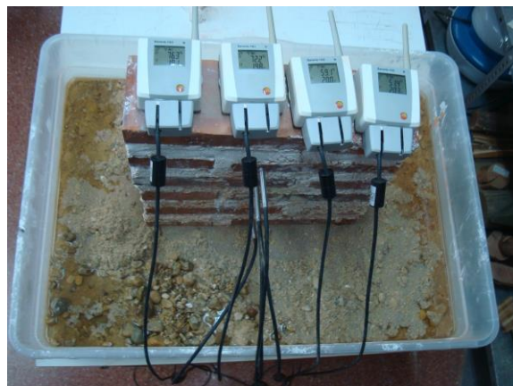
Imágenes 175 y 176. Izquierda, preparando la hidrofugación. Derecha, sondas tomado datos
