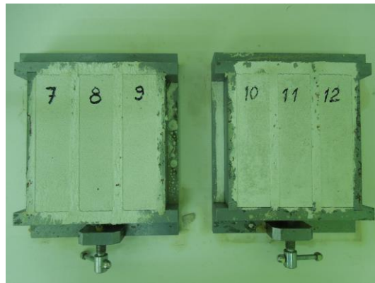
Imágenes 139, 140 y 141. Ejecución de probetas para llevar a cabo el ensayo y secado de las mismas.
