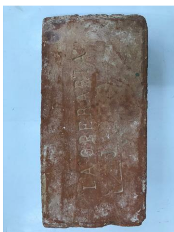
Imágenes 38 y 39. Ladrillos de tejar. A la izquierda vista de la cara opuesta a la que se apoya en el suelo durante el proceso de secado, y a la derecha imagen a simple vista una vez seccionados con sierra de disco
