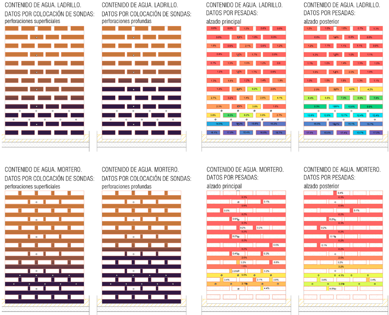
Figura 16. Alzados del muro de 1 ½ asta de ladrillo moderno con barrera hidrófuga. Datos en ladrillos (fila superior) y en argamasa (fila inferior)
