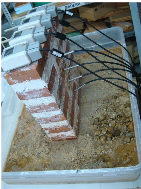
Imágenes 175 y 176. Izquierda, preparando la hidrofugación. Derecha, sondas tomado datos
