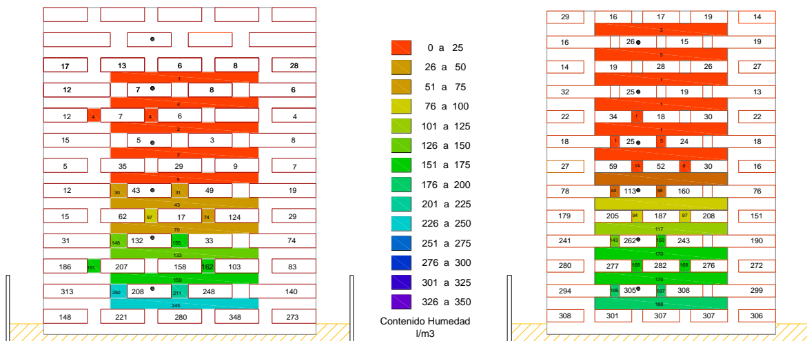
Figura 29. Contenido de humedad en l/m 3 en las juntas de argamasa de los dos muretes. A la izquierda ladrillo de tejar, y a la derecha ladrillo moderno
