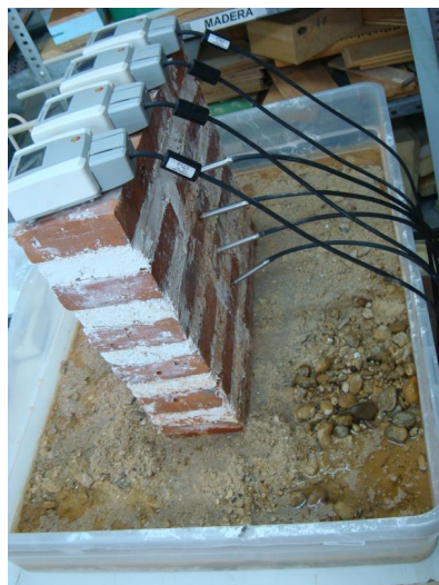
Imágenes 171, 172 y 173. Murete con sondas tomando datos una vez ejecutada la barrera hidrófuga.
