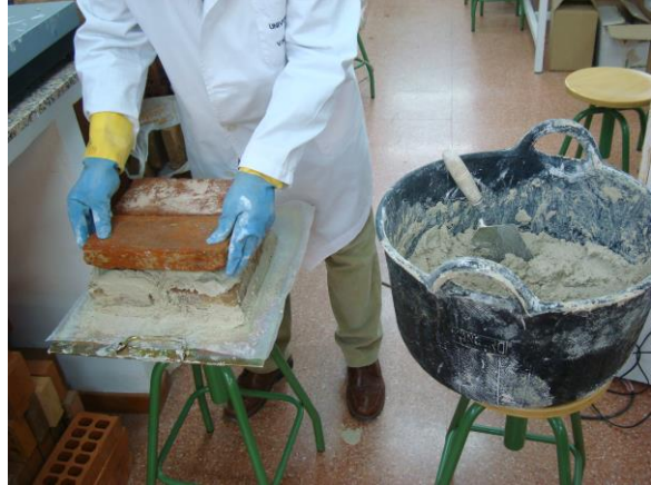
Imágenes 158 y 159. Materias primas, cal y arena y fotografía del proceso de ejecución
