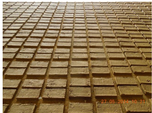
Imágenes 34 y 35. A la izquierda ejemplo de mencial o gradilla. A la derecha imagen de ladrillos de barro secándose antes de su introducción en el horno de leña
