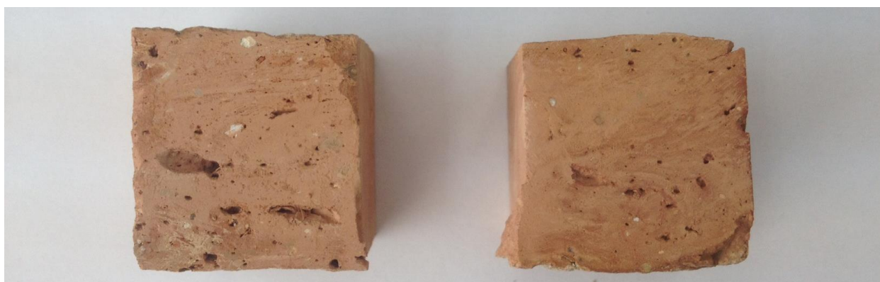
Imágenes 125 y 126. Probetas cúbicas de ladrillos de tejar mientras se ejecuta el ensayo (arriba). Vistas más ampliadas de algunas caras de los cubos una vez ejecutado el proceso de corte (abajo)
