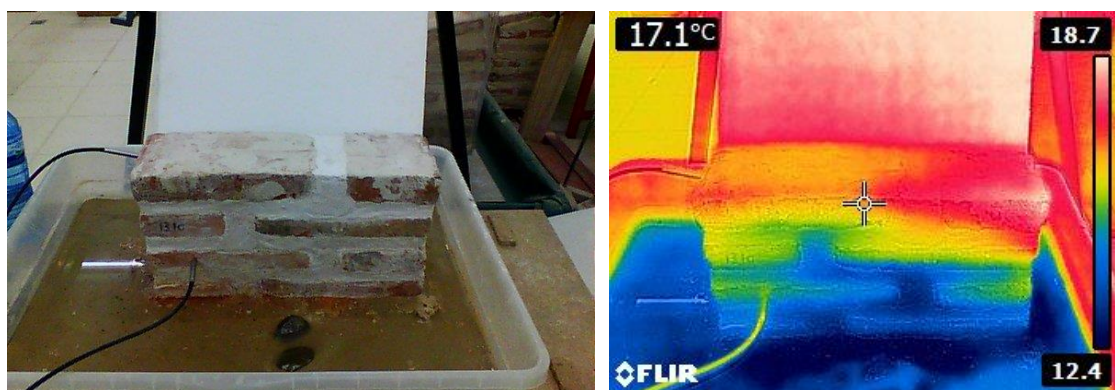
Imágenes 96 y 97. Probeta apoyada sobre lecho húmedo con sondas termohigrométricas e imagen termográfica. El color azul oscuro de la imagen muestra la presencia de agua
