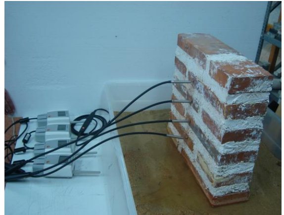
Imágenes 87 y 88. Probeta de fábrica para ensayo 9.1 con las sondas termohigrométricas tomando datos
