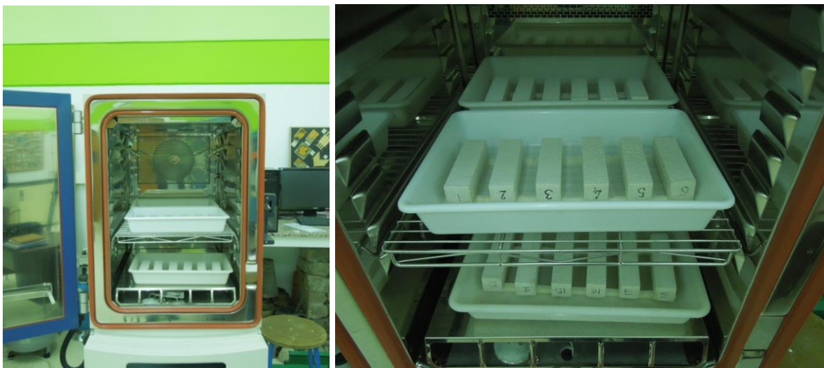
Imágenes 225 y 226. Probetas de argamasa de cal dentro de la cámara climática
