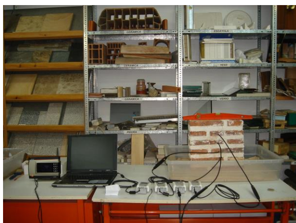
Imágenes 173 y 174. Probeta una vez ejecutada controlando su proceso de secado.
