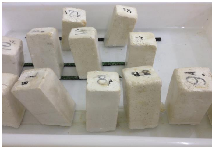
Imágenes 154, 155, 156 y 157. Probetas de argamasa mientras se ejecuta el ensayo.
