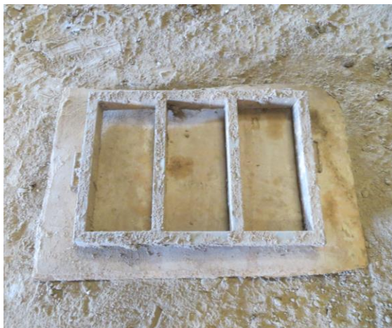
Imágenes 34 y 35. A la izquierda ejemplo de mencial o gradilla. A la derecha imagen de ladrillos de barro secándose antes de su introducción en el horno de leña
