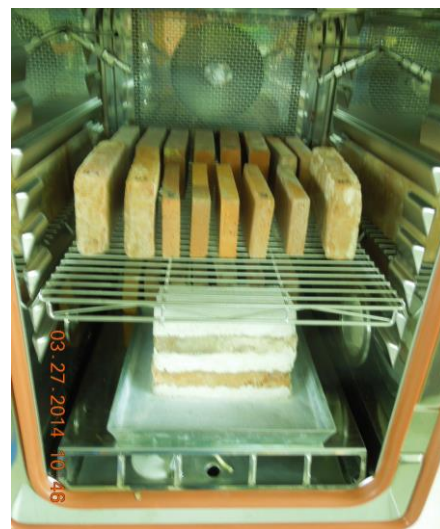
Imágenes 229 y 230. Cámara climática en cuyo interior se ensayan las probetas
