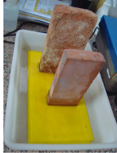
Imágenes 120 y 121. Probetas de ladrillos enteros mientras se ejecuta el ensayo
