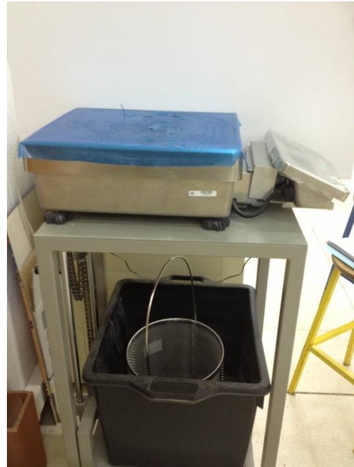
Imagen 279. Con los accesorios que permiten su uso como báscula hidrostática
