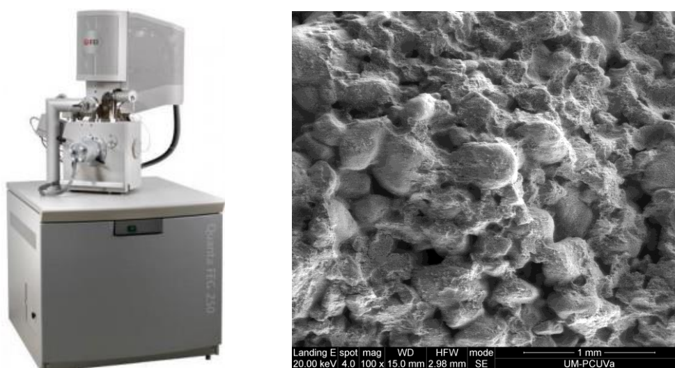
Imagen 283. Microscopio. Foto de la casa. Imagen obtenida con microscopio de este tipo sobre muestra de argamasa de cal 1:3
