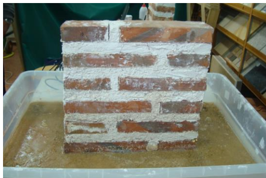
Imagen 168. Murete en el primer proceso de mojado
