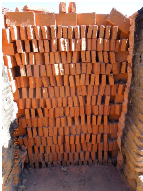
Imágenes 36 y 37. Ladrillos colocados en el horno ("encastillado") y enroje por la zona inferior a base de quemar biomasa: residuos de pinos y bosques, leña, etc. Fotografías tomadas de la visita realizada a la Cerámica Nietos de Eulogio Bernardos sita en el Municipio de Arévalo (Avila) en octubre de 2014. Taller cerámico operativo en la actualidad
