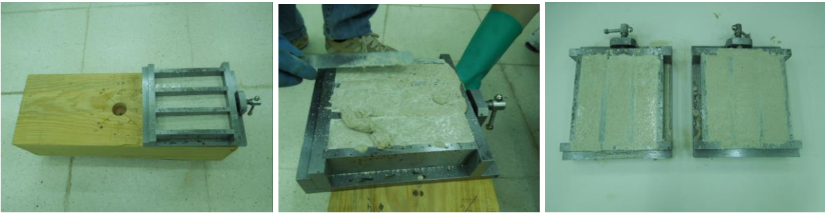
Imágenes 139, 140 y 141. Ejecución de probetas para llevar a cabo el ensayo y secado de las mismas.
