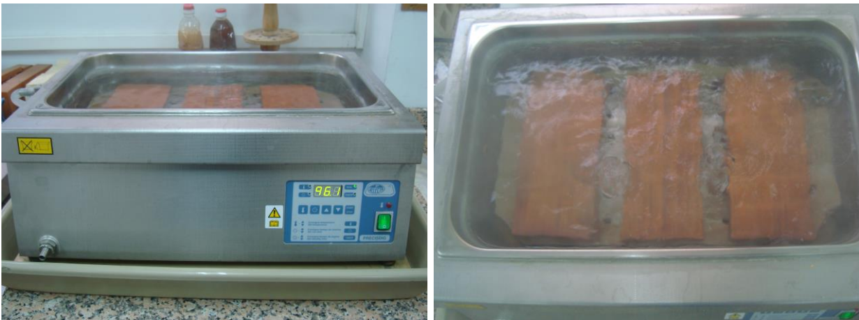
Imágenes 112 y 113. Ladrillos mientras se ejecuta el ensayo
