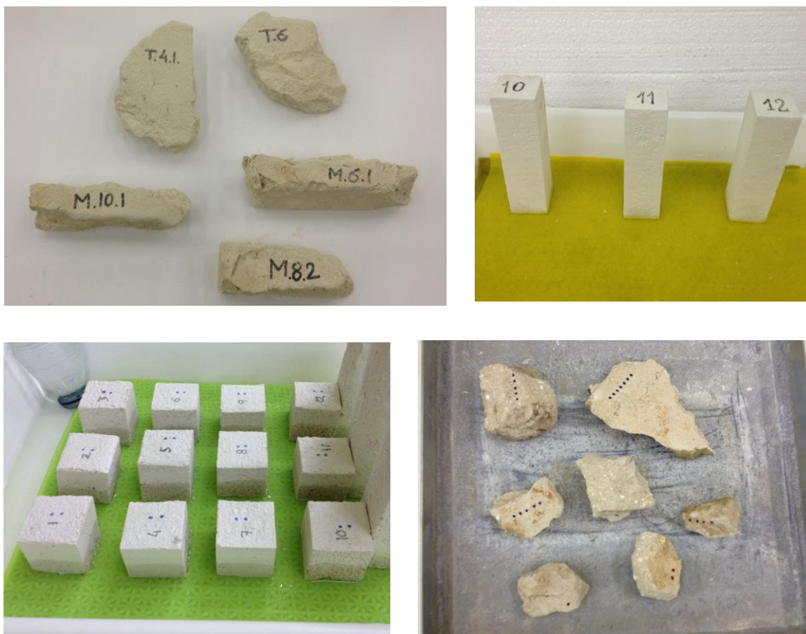
Imágenes 247, 248, 249 y 250. Probetas de argamasa. Arriba: Porciones de argamasa del desmontaje de los 4 muros del ensayo 10.1 y probetas normalizadas de 160x40x40 mm. Abajo: probetas normalizadas de 40x40x40 mm y porciones de argamasa procedentes del derribo de muros de edificaciones antiguas.
