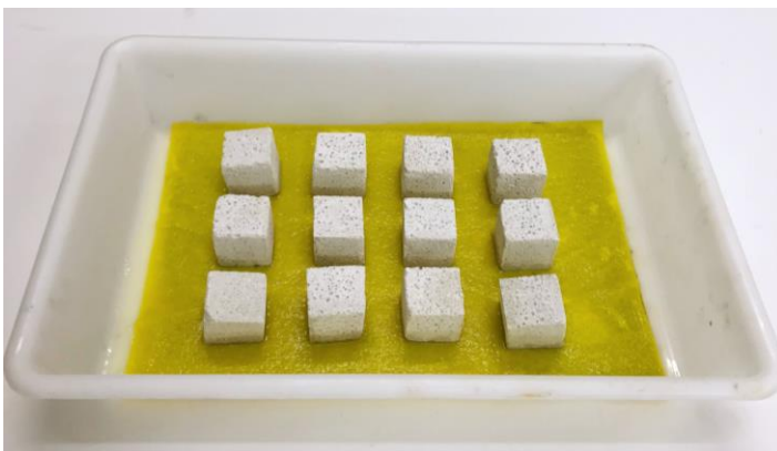
Imágenes 115, 116 y 117. Probetas de argamasa durante la ejecución de los ensayos
