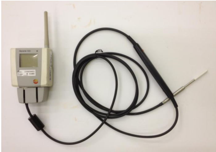
Imágenes 268 y 269. Sondas termohigrométricas y base que recoge los datos
