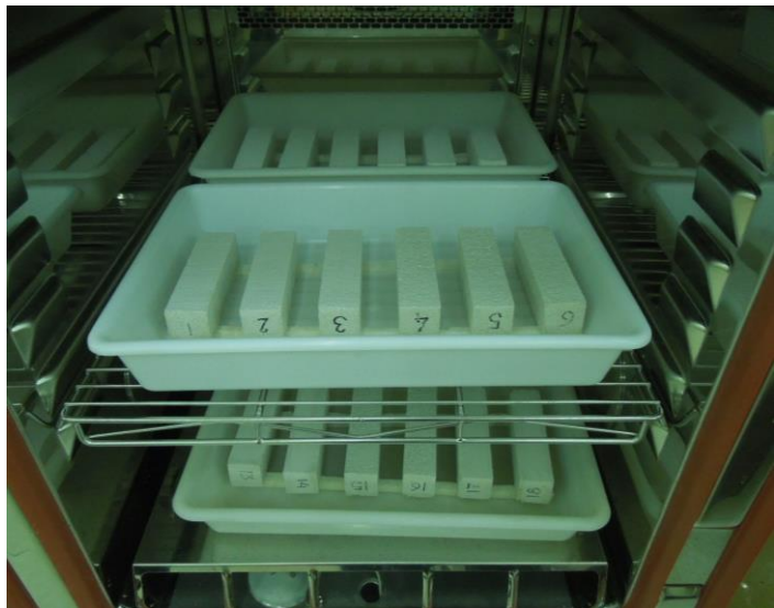
Imágenes 227 y 228. Pesado de probetas y una vez introducidas en la cámara climática
