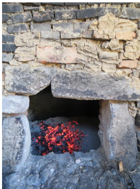
Imágenes 36 y 37. Ladrillos colocados en el horno ("encastillado") y enroje por la zona inferior a base de quemar biomasa: residuos de pinos y bosques, leña, etc. Fotografías tomadas de la visita realizada a la Cerámica Nietos de Eulogio Bernardos sita en el Municipio de Arévalo (Avila) en octubre de 2014. Taller cerámico operativo en la actualidad
