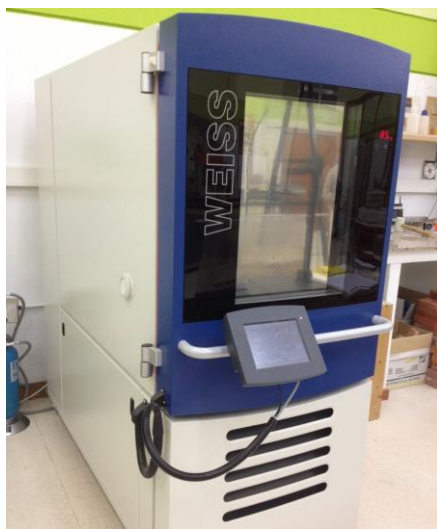
Imágenes 229 y 230. Cámara climática en cuyo interior se ensayan las probetas
