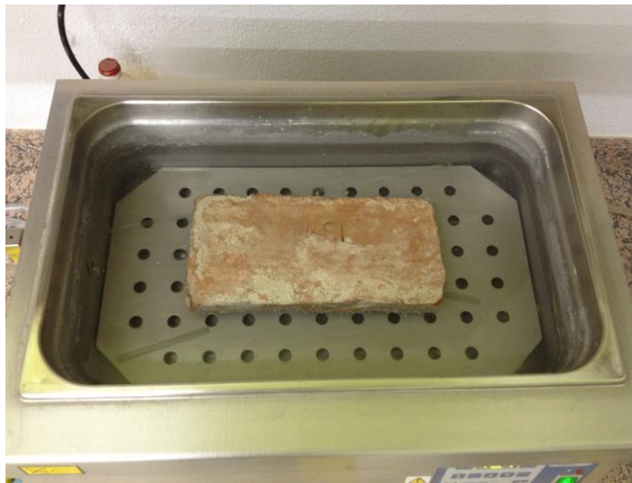
Imagen 114. Ladrillo mientras se inicia el ensayo
