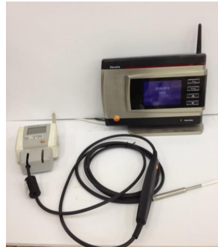
Imágenes 268 y 269. Sondas termohigrométricas y base que recoge los datos
