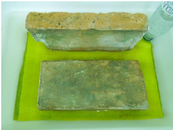
Imágenes 127 y 128. Ladrillos apoyados sobre tabla y canto mientras se ejecuta el ensayo
