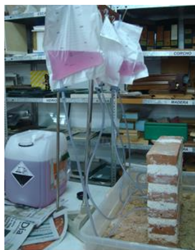
Imágenes 169 y 170. Sellado de las perforaciones y proceso de hidrofugación por gravedad
