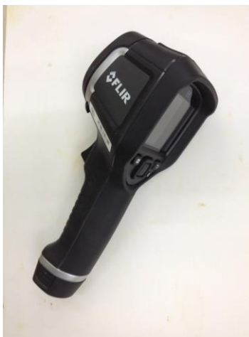
Imagen 273. Imagen de la cámara termográfica
