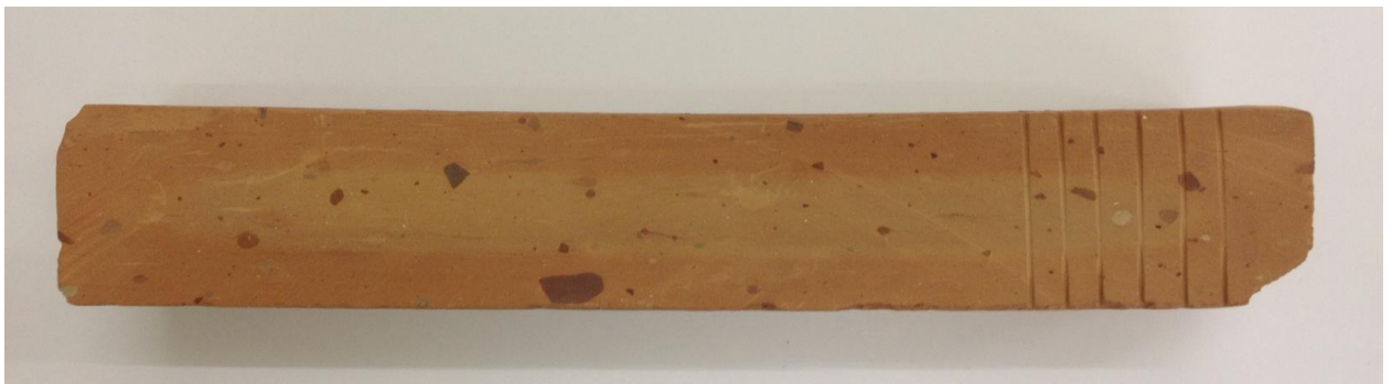
Imágenes 54, 55 y 56. Ladrillo de ejecución moderna por extrusión. Obsérvese en la sección como la zona central no presenta siempre el mismo tono, por falta de cocción.
