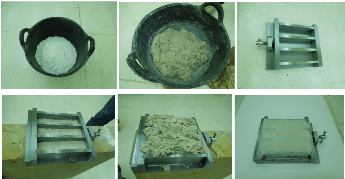
Imagen 133, 134, 135, 136, 137 y 138. Materia prima, preparación, molde y ejecución de probetas
