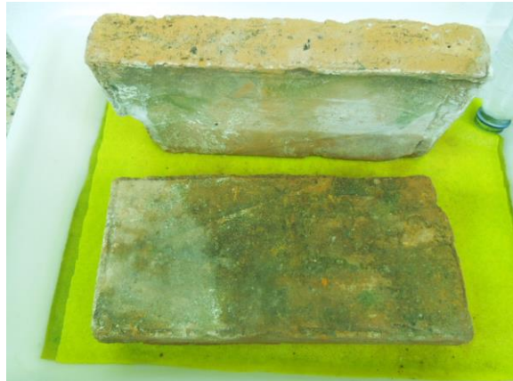
Imágenes 127 y 128. Ladrillos apoyados sobre tabla y canto mientras se ejecuta el ensayo
