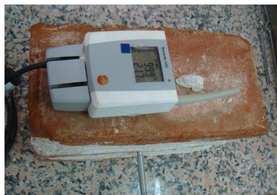
Imágenes 245 y 246. Sonda termohigrométrica y ésta tomando datos de una probeta
