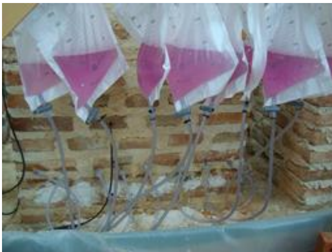
Imágenes 16 y 17. Ejemplo de introducción de producto hidrofugante por gravedad para generar una barrera de corte hídrico en dos de los ensayos realizados
