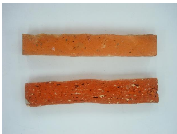
Imágenes 38 y 39. Ladrillos de tejar. A la izquierda vista de la cara opuesta a la que se apoya en el suelo durante el proceso de secado, y a la derecha imagen a simple vista una vez seccionados con sierra de disco
