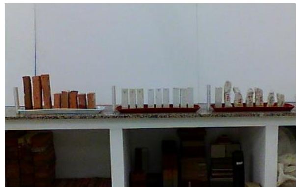
Imágenes 233, 234. Izqda. Probetas argamasa de porciones del desmontaje del E 10.1. Dcha. Todas las probetas
