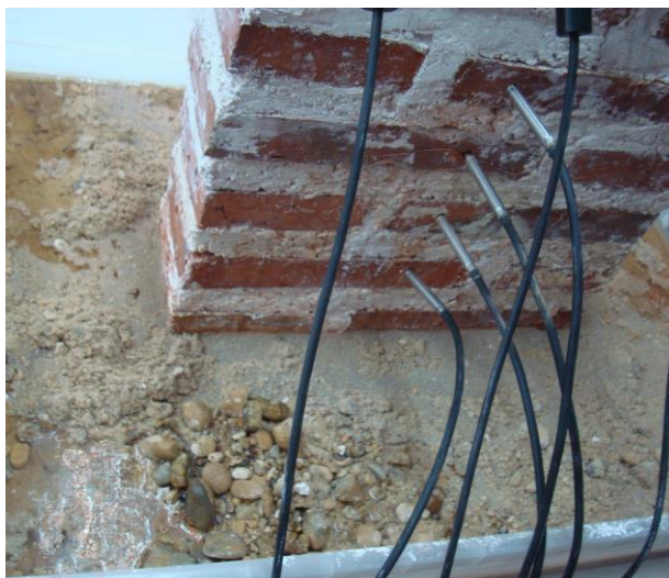
Imágenes 171, 172 y 173. Murete con sondas tomando datos una vez ejecutada la barrera hidrófuga.
