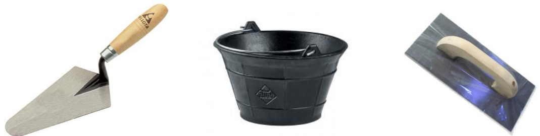
Imágenes 291, 292 y 293. Instrumental usado para la preparación de las probetas
