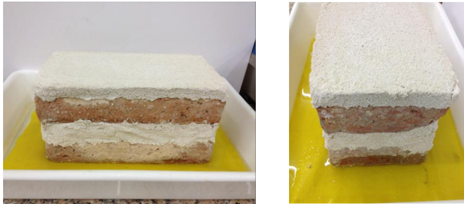
Imágenes 98 y 99. Probeta apoyada sobre lecho húmedo durante el ensayo.
