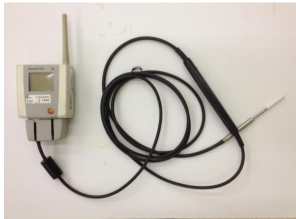
Imágenes 31 y 32. Imagen tomada con la cámara termográfica. El color azul indica presencia de agua. A la derecha sonda termohigrométrica. En el extremo se ubica el sensor que mide los valores de humedad y t°
