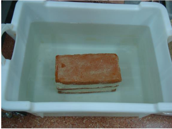
Imágenes 162 y 163. Probeta sumergida en agua fría
