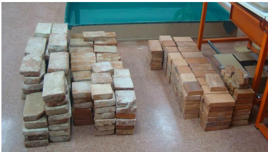
Imagen 30. Acopio de ladrillos antes de la ejecución del ensayo 10.1 sobre los cuatro muros a la izquierda los ladrillos antiguos de tejar y a la derecha los modernos imitación rústico
