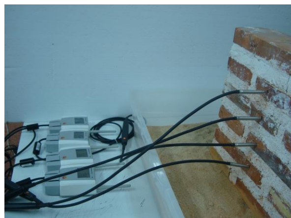
Imágenes 173 y 174. Probeta una vez ejecutada controlando su proceso de secado.
