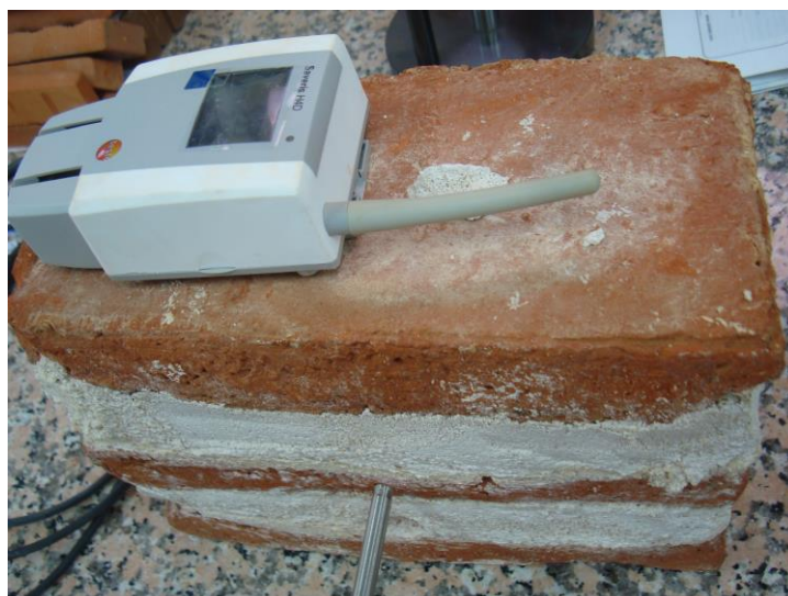
Imágenes 164 y 165. Probeta una vez extraída del agua y comenzando el proceso de desorción y sonda termohigrométrica tomado datos de humedad y temperatura en perforación.
