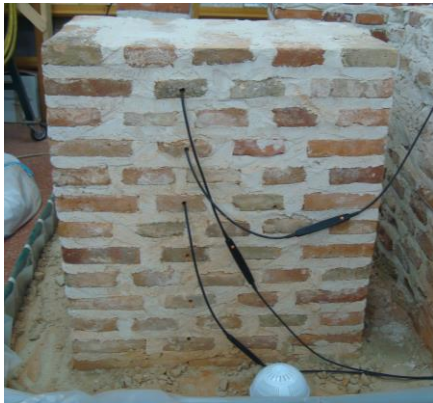
Imagen 252. Muro de ladrillo de tejar con las sondas sobre la base de arena
