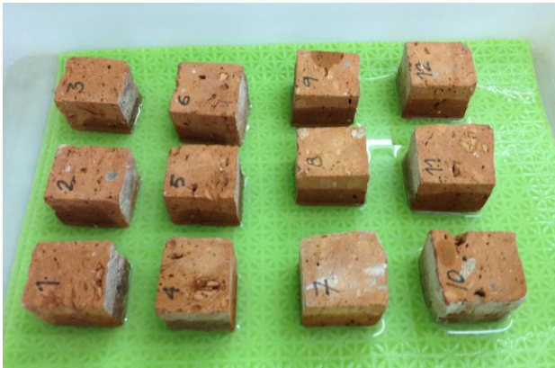
Imágenes 75 y 76. Probetas normalizadas de ladrillo de 40 x 40 x 40 mm durante un ensayo
