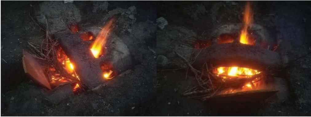
Fig. 98. Horno cargado de leña: Quemado para su compactación.
