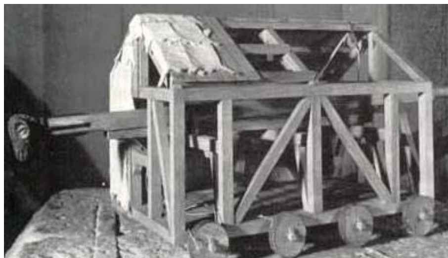
Vista lateral y frontal de un testudo arierata . Museo de la Civilización Romana (Roma). Fuente: (Liberati, 1997)
