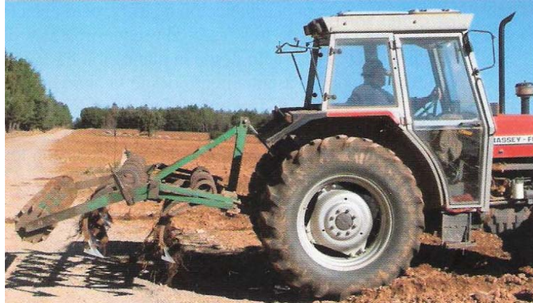
Cultivador con rodillo para regular profundidad de laboreo
