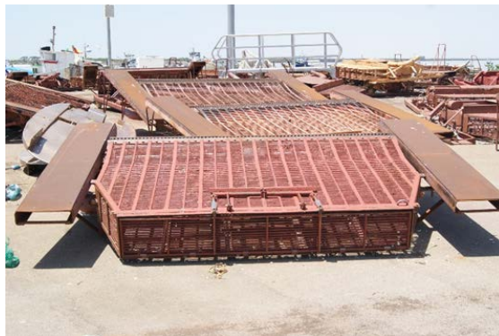
Figura 3. Jaulas de las dragas hidráulicas, Sanlúcar de Barrameda.
