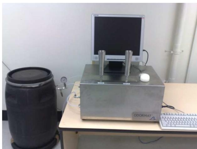
**Figura I.4.** Olfatómetro de dos puertos de elección forzada. Cortesía de University of New South Wales.
