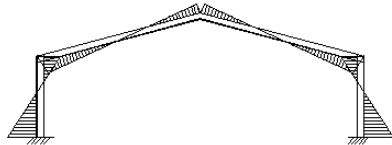
Diagrama de Flectores debido a H
