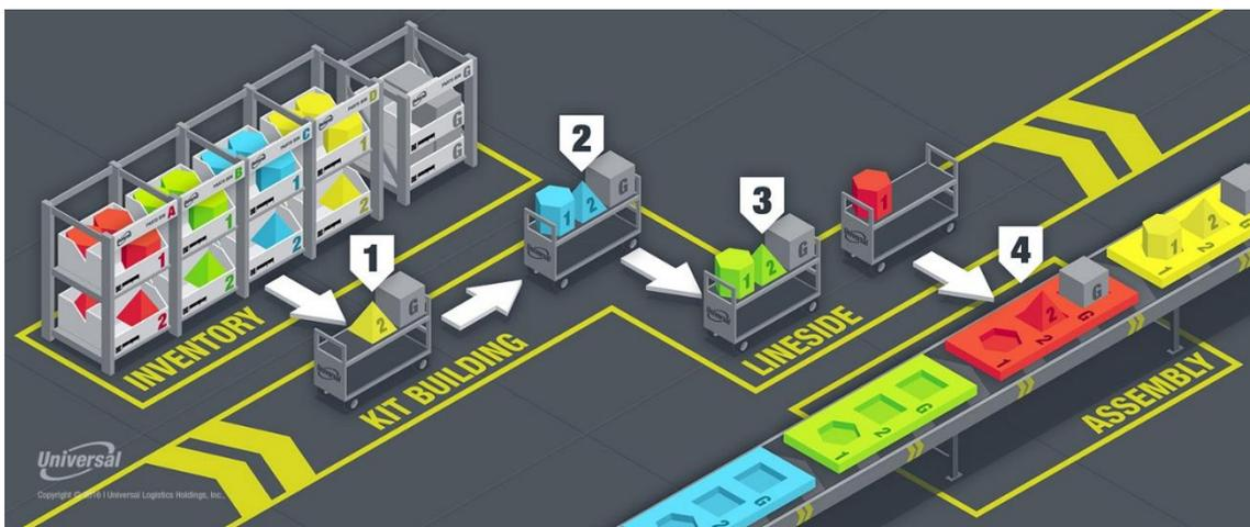
Figura 13, funcionamiento básico de un sistema de kitting (universallogistics.com)
