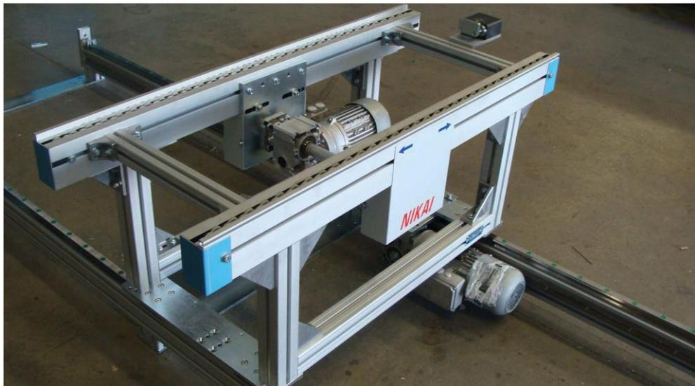
Figura 92 Sistema Shuttle
