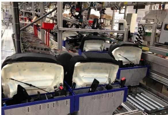
Figura 35 El funcionamiento óptimo incluye dos cajas esperando para entrar a la línea
