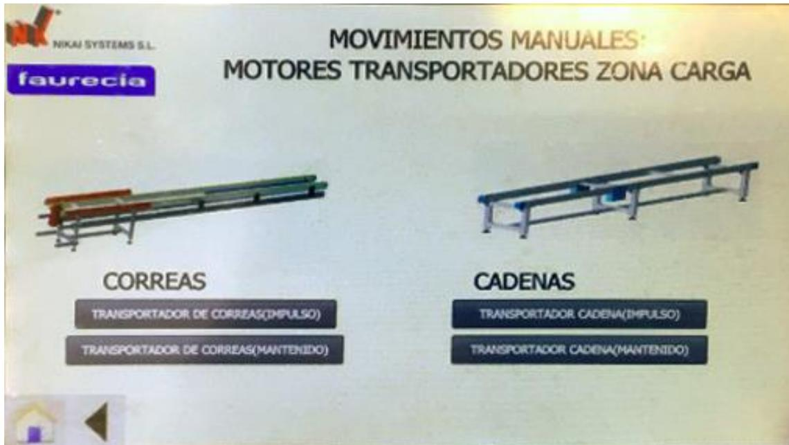
Figura 56 Accesos al movimiento de los motores transportadores
