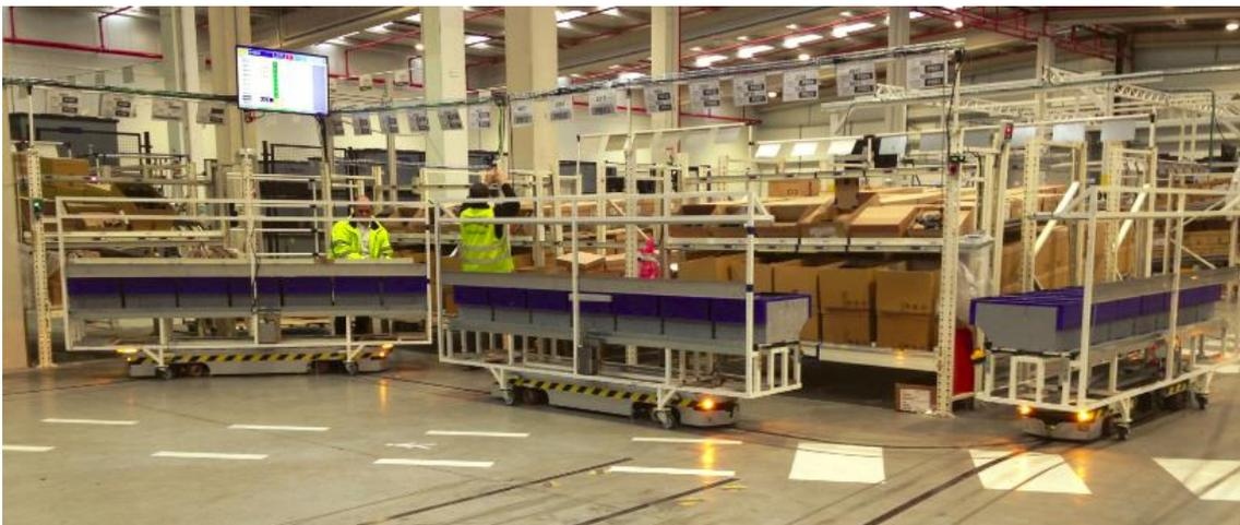
Figura 89 AGVs esperando a que terminen las labores de picking
