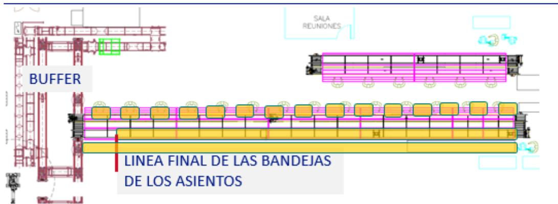
Figura 21 La línea roja marca el espacio ocupado por las bandejas en el retorno de bandejas cuando este está lleno.
