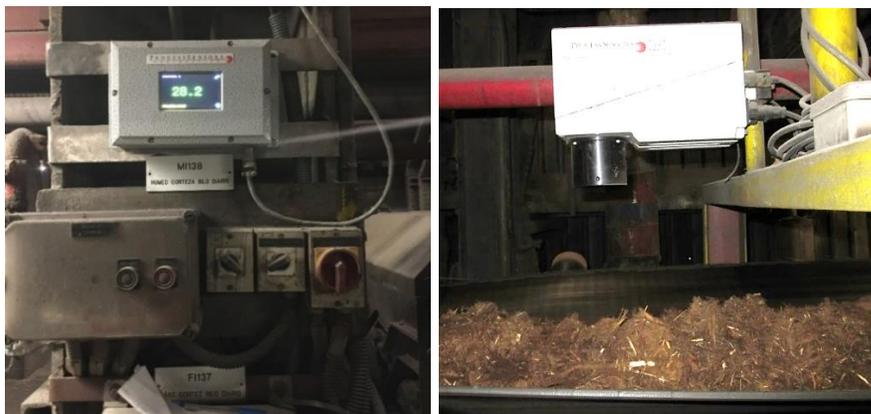
**Figura 8: Foto del equipo de infrarrojo – medidor de humedad.**
