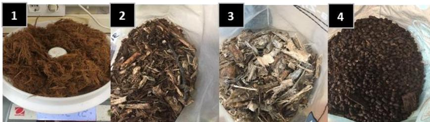
**Figura 5: Tipos de biomazas calibrados: Corteza del Parque de Madera (1), Mezcla de Aprovechamiento Forestal (2), Pino Astillado (3) y Orujillo (4).**
