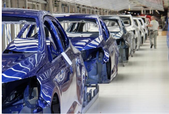
Imagen 2.5.4.3.: Línea de retoque y terminación del proceso de Pintura. Fuente: Departamento de Comunicación, Renault Palencia.
