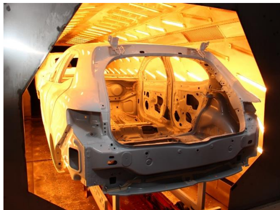
Imagen 2.5.4.2.: Estufa de secado del barniz.
