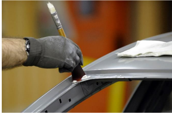
Imagen 2.5.2.1.: Aplicación manual de mástico.
