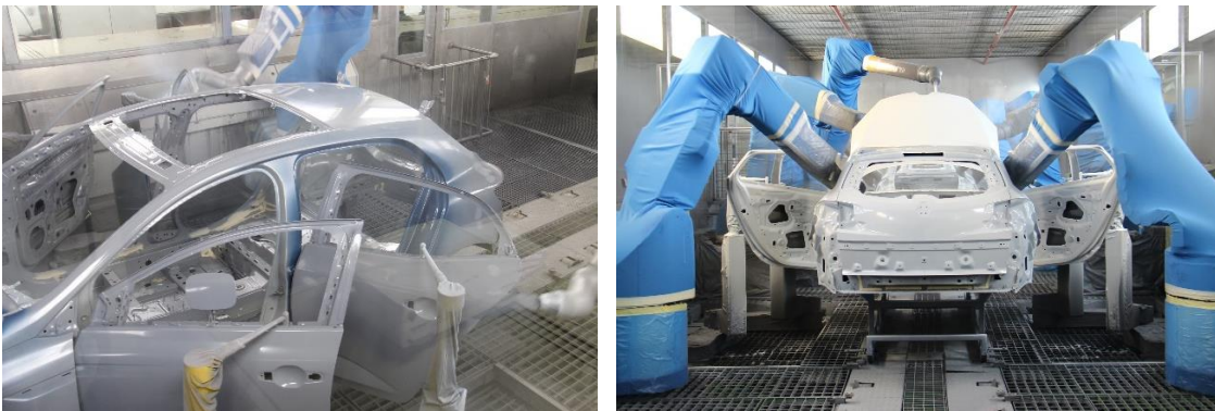
Imagen 2.5.4.1.: Cabina de bases al agua.
