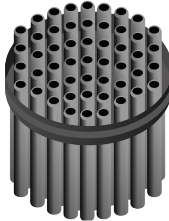
Ilustración 17. Disipador de calor de una luminaria LED
