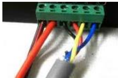
Ilustración 46. Ejemplo de conexión Dimmer RGBW
