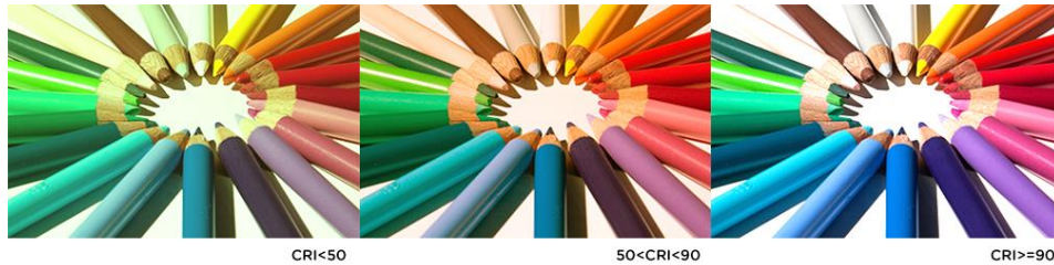
Ilustración 5. Fotografía con diferentes niveles de IRC
