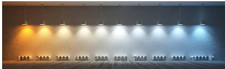
Ilustración 3. Rango de temperatura de color
