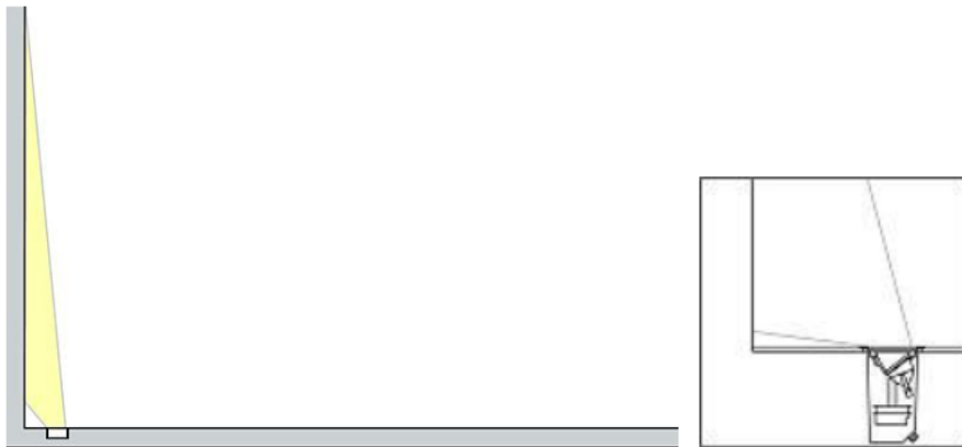
Ilustración 19. Luminaria empotrada en suelo
