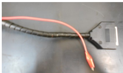
Figura 67. Protección de cables y conector.
