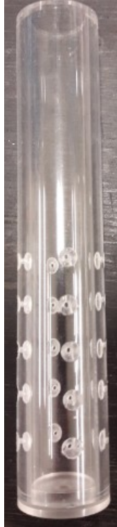
Figura 59. Tubo de metacrilato con agujeros.
