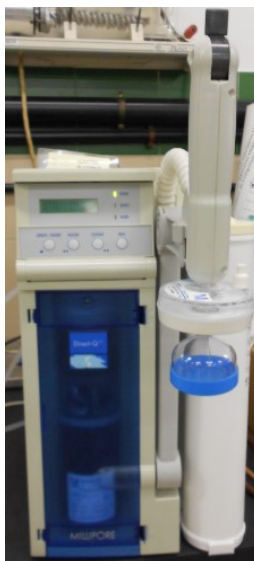
Figura 32. Desionizador de agua.
