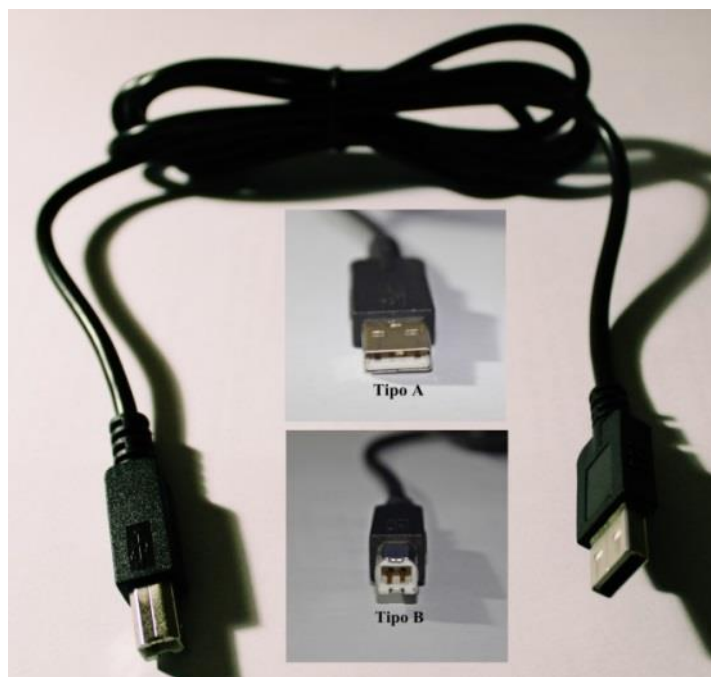
Imagen 22. Cable para la conexión entre el ordenador y Arduino Uno.
