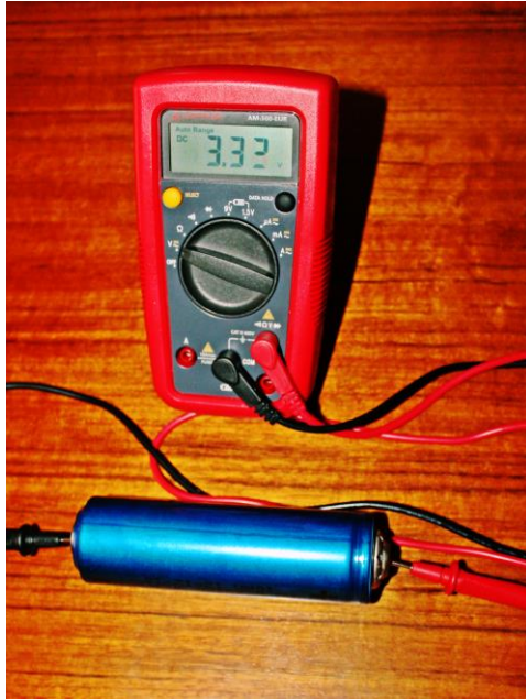
Imagen 17. Tensión en vacío de la celda 5
