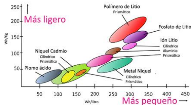
Figura 11. Celda de \text{LiFePO}_4 en comparación con los demás tipos de celdas [19].
