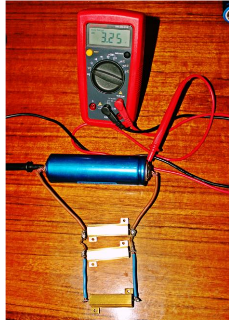
Imagen 18. Tensión en carga de la celda 5.
