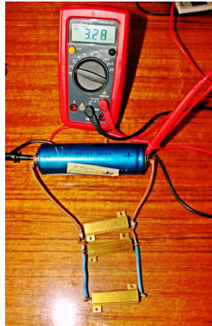
Imagen 16. Tensión de la celda 4 con la carga.
