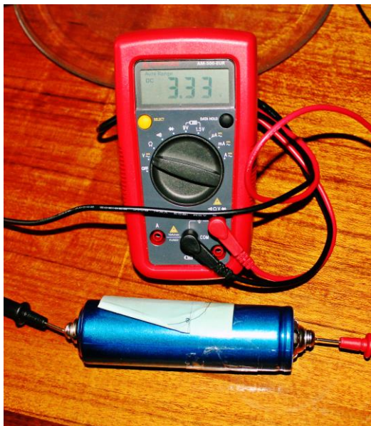
Imagen 12. Tensión en vacío de la celda 1
