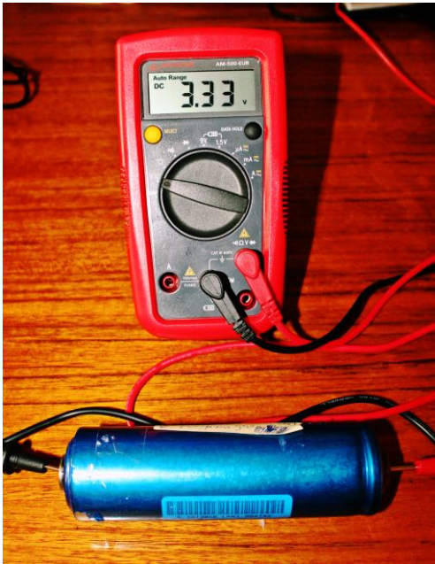
Imagen 15. Tensión en vacío de la celda 4.
