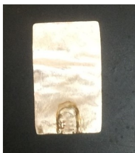
Figura 5. Contraelectrodo (Placa de platino).
