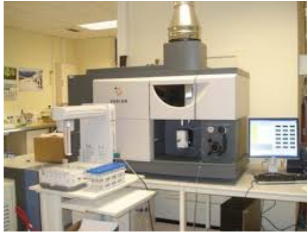
Figura 2.13: Equipo de Espectroscopía de Absorción Atómica ICP-MS con un sistema de Reacción Octopolar HP 7500c de Agilent.[46]
