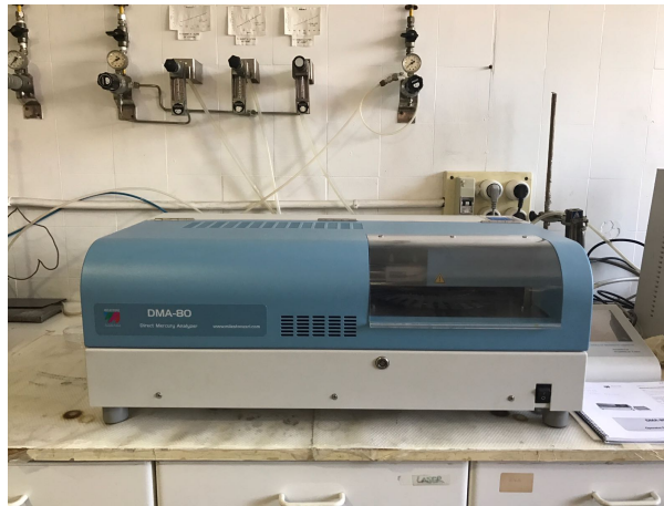
Figura 2.15: Equipo de Análisis de mercurio, modelo DMA-80 de Milestone.[48]
