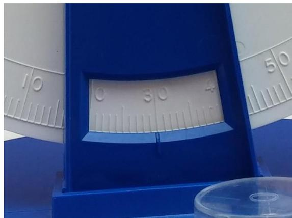
Figura 20: goniómetro detalle de la lectura de ángulos verticales.
