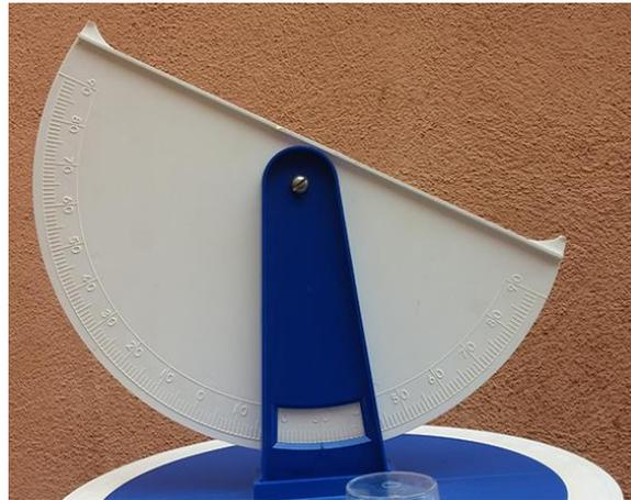
Figura 19: goniómetro. Detalle de la mira y el alza.
