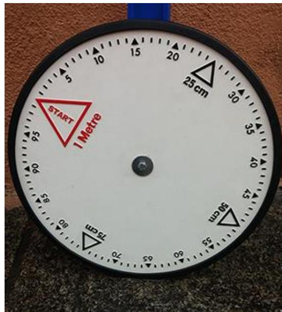
Figura 24: Odómetro. Si terminamos en esta posición, tendremos que sumar 65cm a la distancia recorrida con las vueltas completas.
