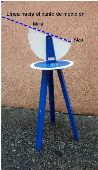
Figura 18: goniómetro. Visual para medir el ángulo.
