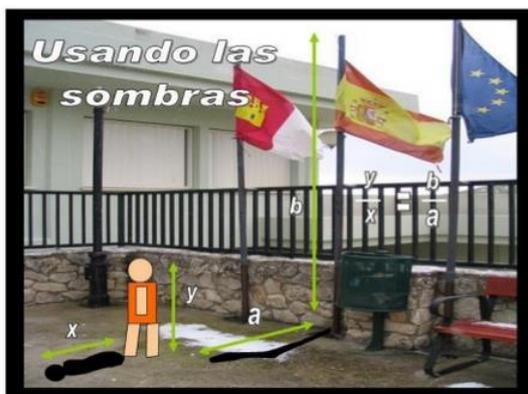
Figura 7: medición de la altura de las banderas por el método de la sombra.
