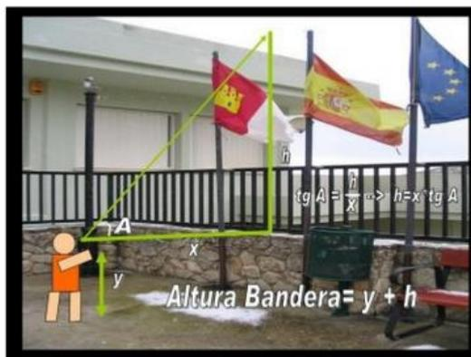
Figura 8: medición de la altura de las banderas a través de la tangente.
