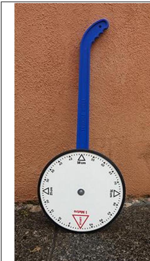
Figura 23: odómetro posicionado a cero.
