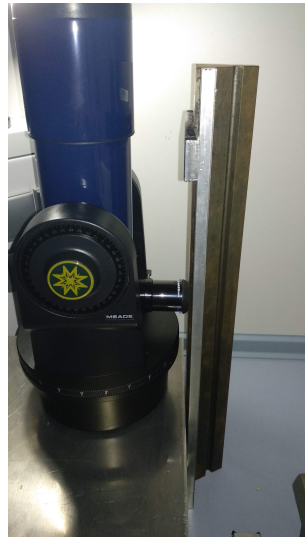
Figura 3.1: Ocular del Telescopio y plataforma situados en la misma vertical
