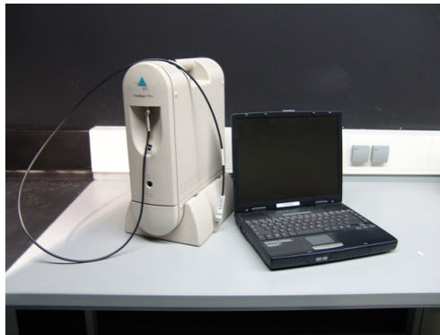
Figura 2.1: Espectrorradiómetro de campo ASD
