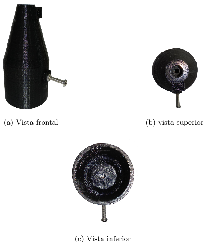
Figura 5.1: Adaptador impreso en 3D
