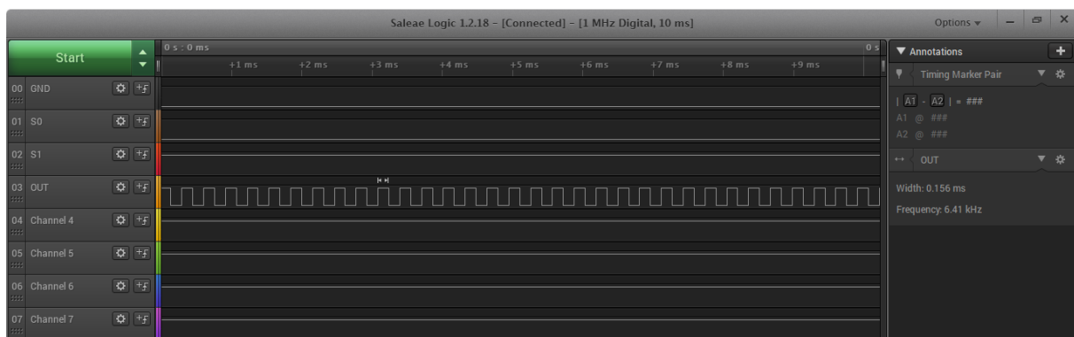
Figura 53. Datos obtenidos de la segunda muestra del convertidor de luz-frecuencia
