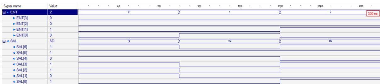
Figura 25. Simulación del convertidor BCD-7segmentos
