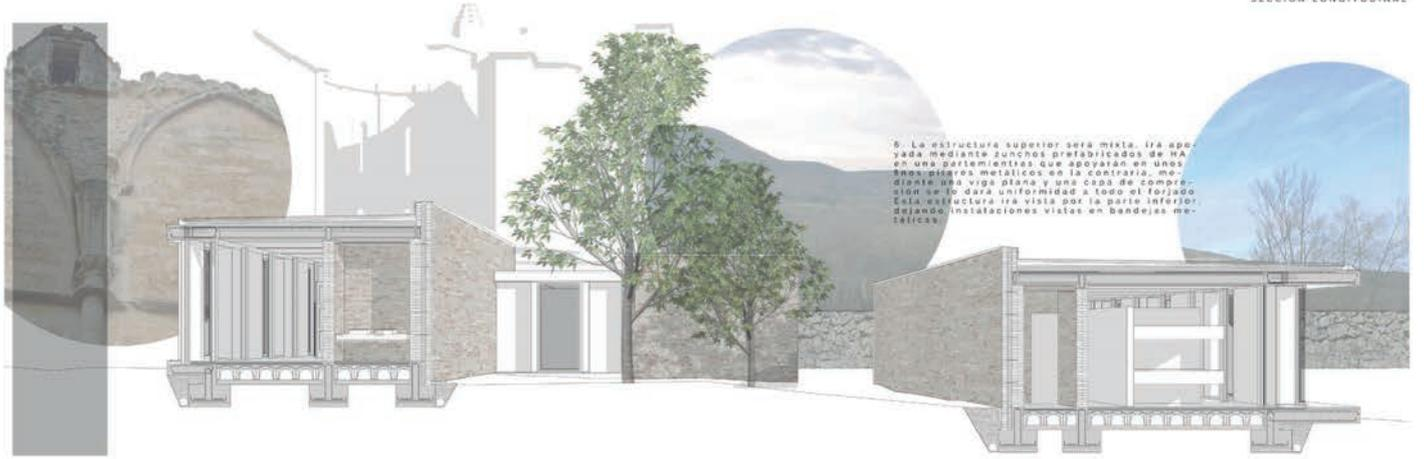
6. La estructura superior será mixta, irá apoyada mediante zunchos prefabricados de HA en una partermentes que apoyarán en unos mampostera metálicos. En la contraria, mediante una viga plana y una capa de compresión se lo dará uniformidad a todo el forjado. Esta estructura irá vista por la parte inferior dejando instalaciones vistas en bandejas metálicas.
