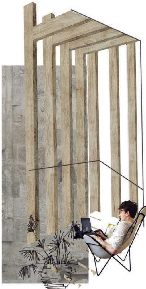
pilares de madera laminada de 100x250 mm con separación de 400mm
