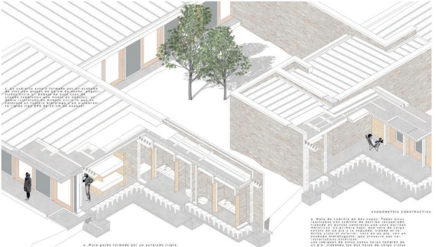
1. La cubierta estará formada por un acabado de zinc ón plomo de 30 cm de ancho, encajadas entre sí. Debajo de esta capa de acabado tendremos una manija de néctulo, un doble rastreado de madera ontría que se colocará un aislero hidrofugo y un aislamiento rígido tipo EPS que lo cm de espesor.
