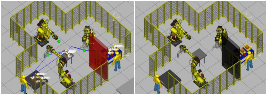
Figura 175. Robot parado ante tramo de valla añadido.
