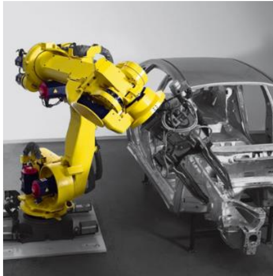
Figura 5. Robot de soldadura resistiva por puntos.
