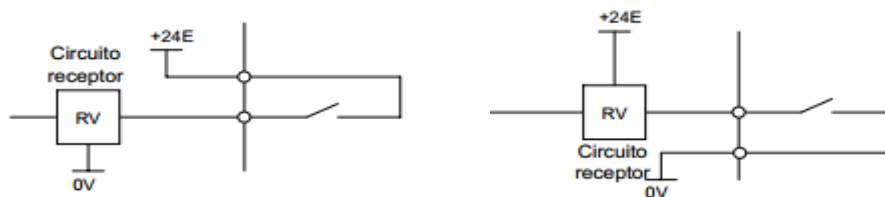
Figura 63. Izquierda: Entrada polaridad positiva. Derecha: Entrada polaridad Negativa.
