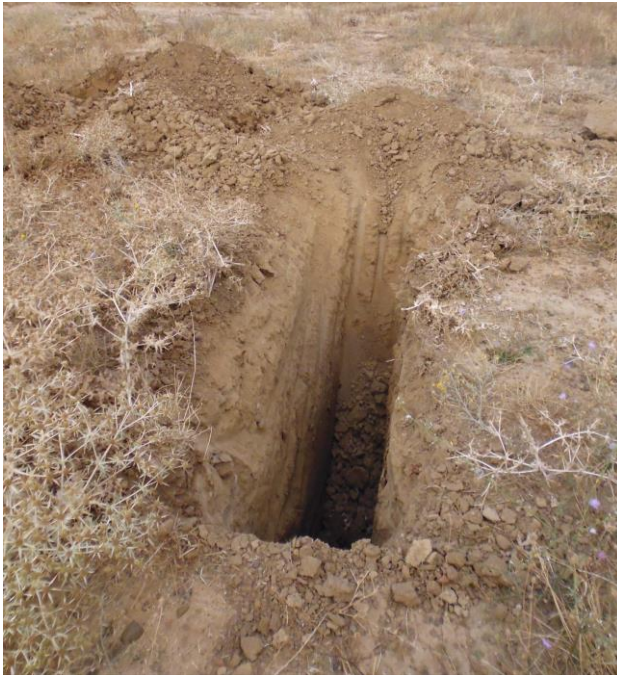
Ilustración 2. Cata 1: Firme compacto a partir de 30 cm, bajo capa vegetal. Terreno cohesivo arcilloso – arenoso con matriz de gravas gruesas.
