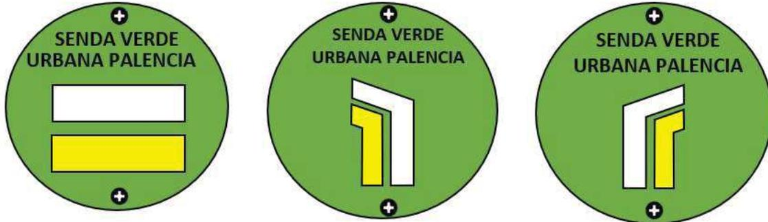
Figura 7: Chapas que definen el tipo de baliza vertical, ya sea de continuidad, de giro a la izquierda y de giro a la derecha. Fuente: Elaboración propia
