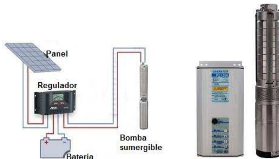
Fig. 13: Regulador de carga y bomba sumergible
