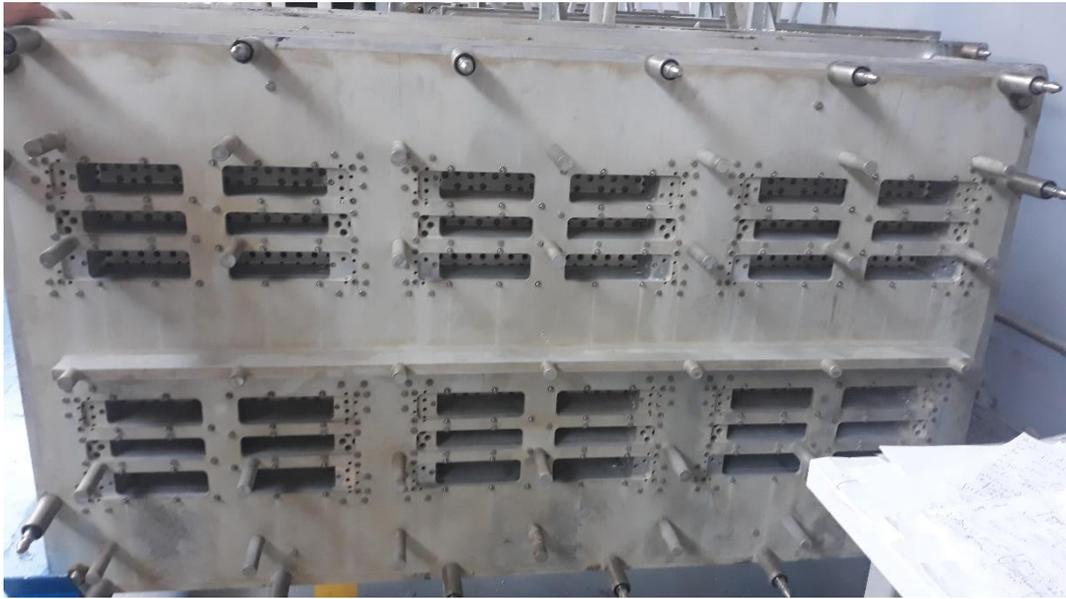
*Fotografía 5: Molde por la parte delantera donde se acopla a la máquina, se muestra las seis cavidades*
