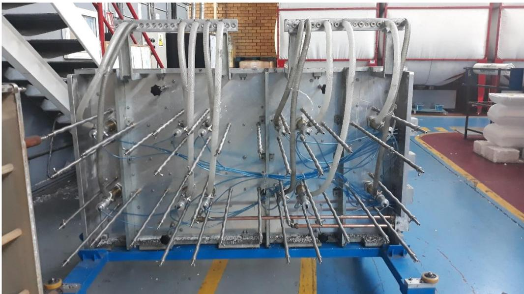
*Fotografía 6: Molde por la parte trasera donde están colocados los expulsores y los conductos de inyección*
