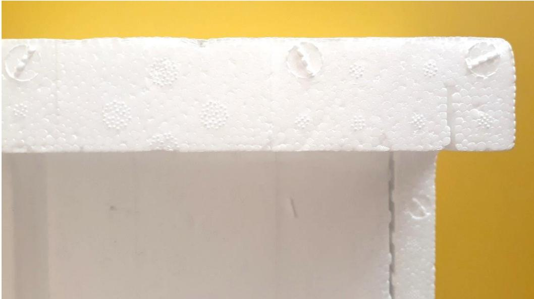
*Fotografía 3: Marcas generadas por las cabezas de los tornillos que ajustan el postizo al molde*
