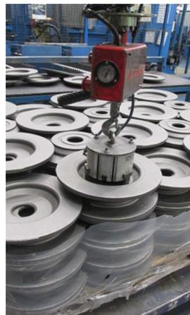
Figura 37: Posición del manipulador sobre el bruto
