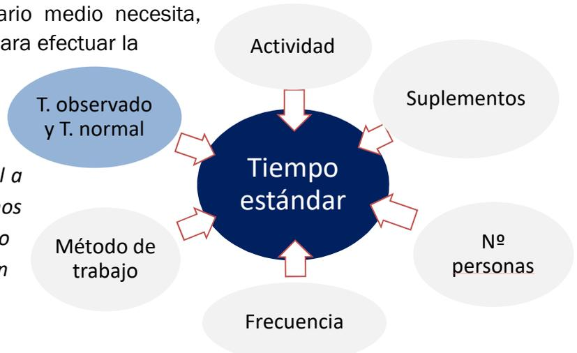
Figura 9: Esquema tiempo normal
