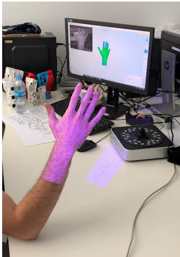
Ilustración 50 - Digitalización 3D de la mano
