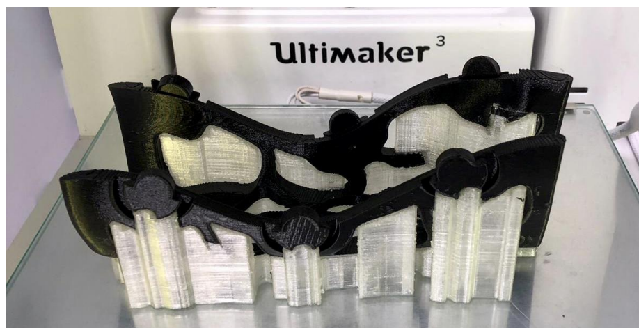
Ilustración 98 -Pieza de PLA (ácido poliláctico) con soporte de PVA
