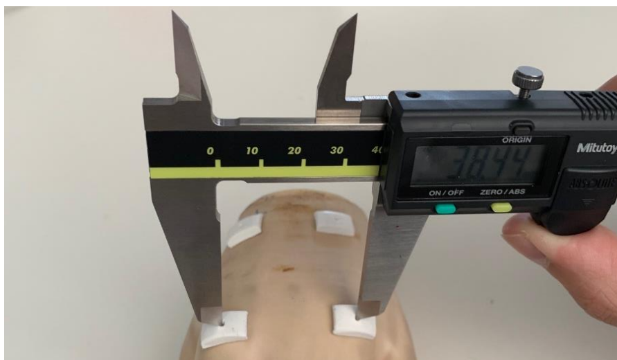
Ilustración 27 - Medida con pie de rey
