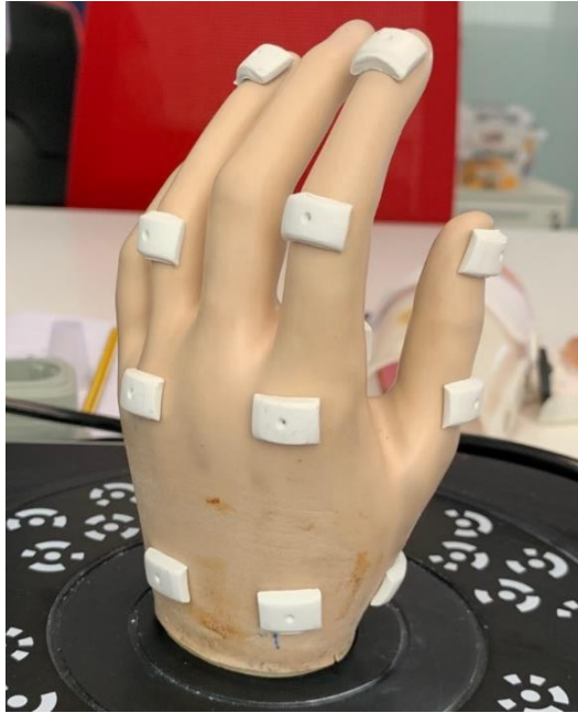
Ilustración 26 - Mano con las referencias de medida
