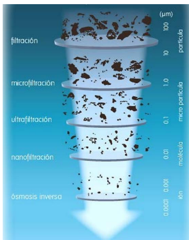
Figura 17. Tipos de filtración con membrana.
