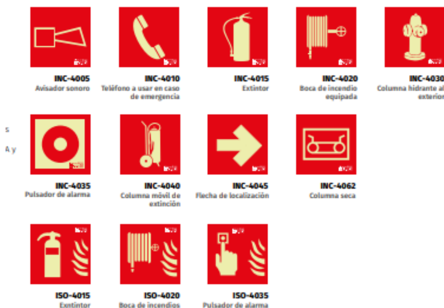
Ilustración 2. Señalización para la protección contra incendios.
