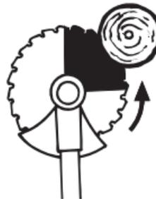
Figura 6.9. Zona peligrosa de trabajo de la motodesbrozadora.
