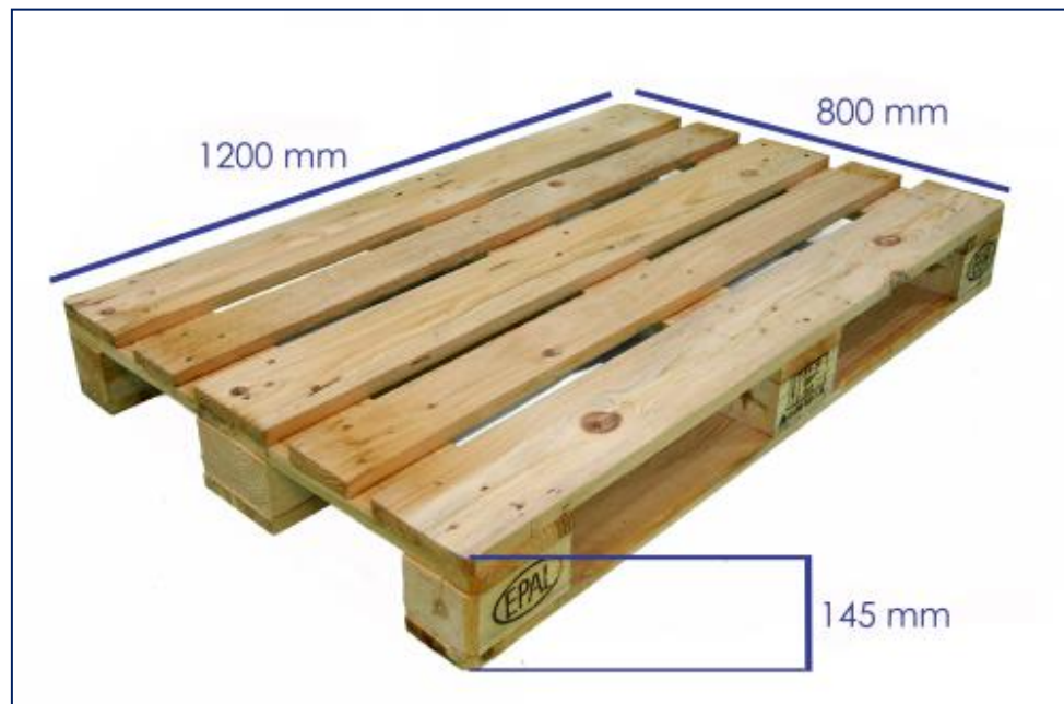
Figura 4.7 Dimensiones de un pallet europeo (Garvi, 2018).
