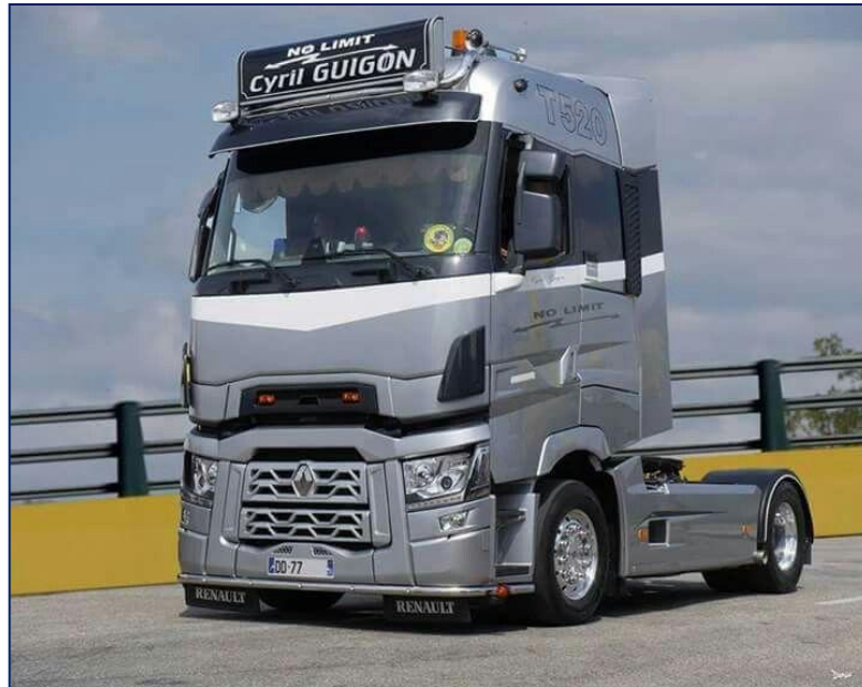
Figura 3.4 Vista de una cabina con una configuración cabover (Huijbregts, 2018).
