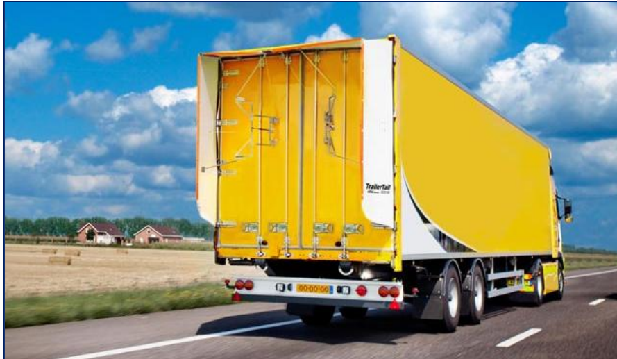
Figura 3.2 Ejemplo de alerones plegables en la parte posterior de los camiones (Garriga, 2012).
