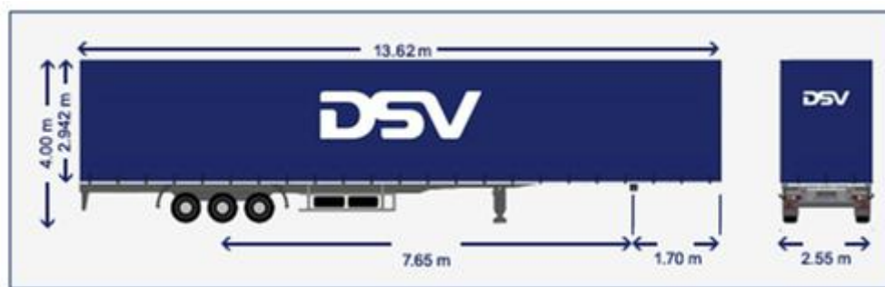
Figura 4.4 Dimensiones exteriores del tráiler (DSV, 2018).
