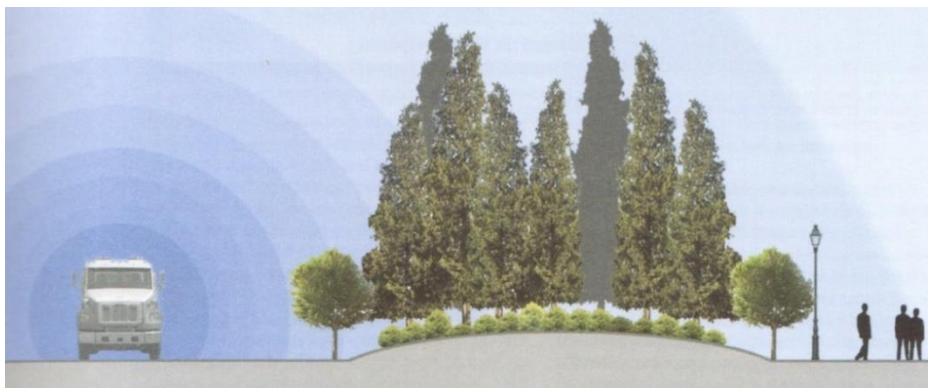
Fig. 4.6. Barreras de pinos y abetos de 18-38 m de ancho causan una reducción de 10 dB en frecuencias bajas. Barreras arbustivas causan una reducción de 5-8 dB en ruidos de circulación. (Salvo et al. 1993, 103). Véase Anexo 1.
