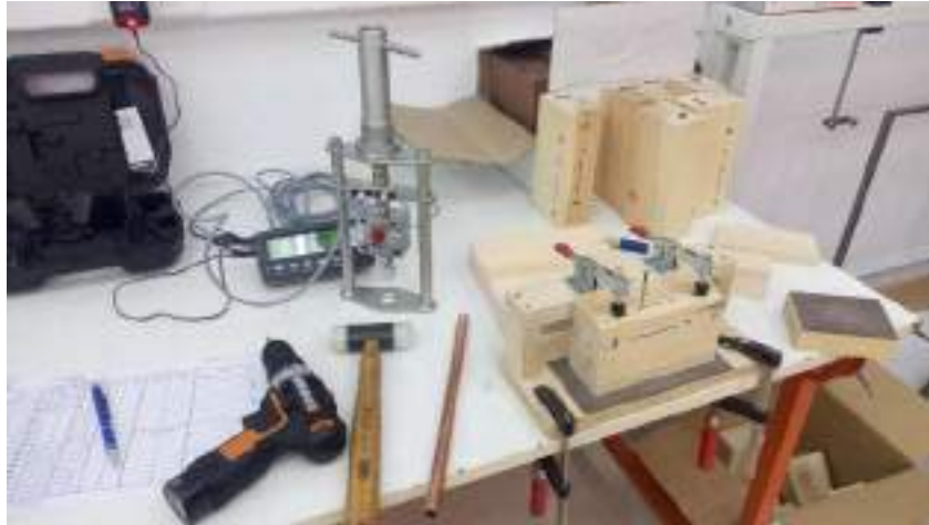
Figura 12. Puesto de trabajo del ensayo de arranque de tornillos.
