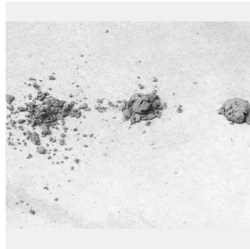
Figura 37: Imagen de los tres posibles resultados del experimento para probar la humedad de la tierra. Fuente: Ceramic Houses & Earth Architecture
