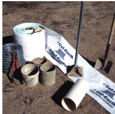
Figura 40: Imagen de las herramientas necesarias (alambre, tenazas, sacos y latas para llenarlos y pisones). Fuente: https://www.calearth.org/intro-superadobe
