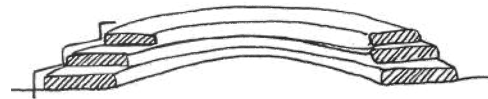
Figura 65: Retranqueo para colocar los sacos. Elaboración propia basada en esquemas del libro Ceramic Houses & Earth Architecture
